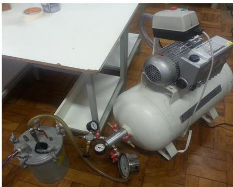
Figura 35: Bomba de vácuo.
