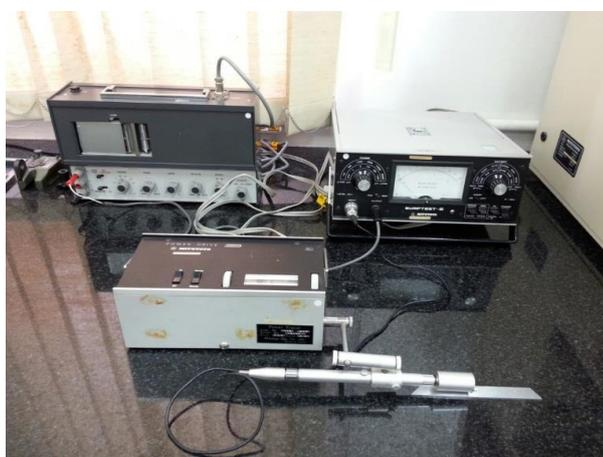
Figura 28: Rugosímetro utilizado para medição da rugosidade das superfícies (cortesia Helibras)
