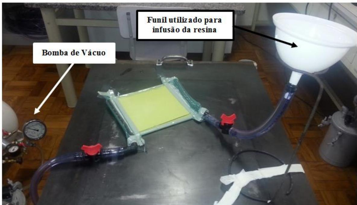
Figura 34: Montagem final da bolsa de vácuo e o processo de infusão de resina no corpo de prova.
