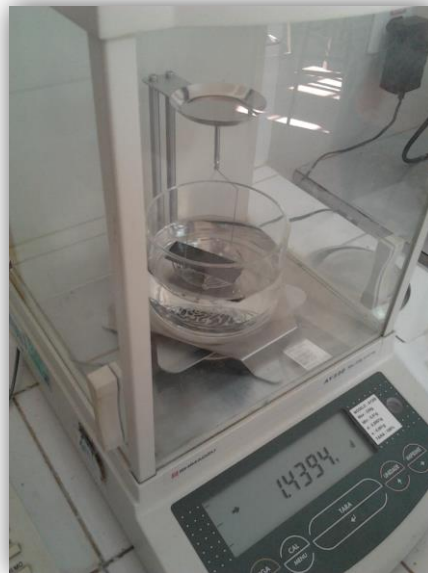
Figura 3.11 - Medição da massa específica pelo método de Arquimedes
