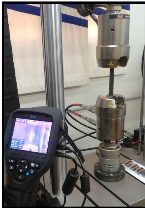
Figura 3.15 - Monitoramento dos ensaios de fadiga com a câmera térmica
