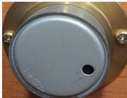
**Figura 6.10 – Tacômetro usado na bancada de testes.**
