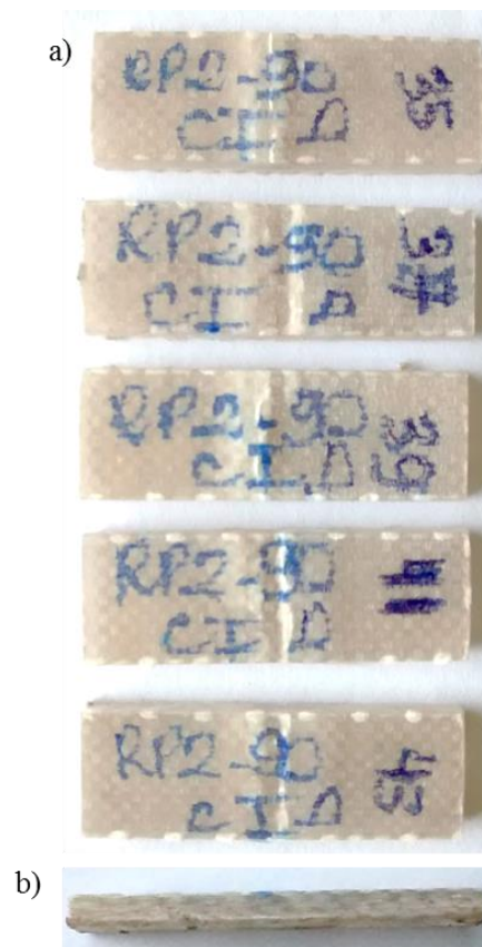
Figura 43- Falha característica do ensaio de cisalhamento interlaminar com vista superior (a) e vista lateral(b) do corpo de prova após o ensaio. Fonte: autor (2015)
