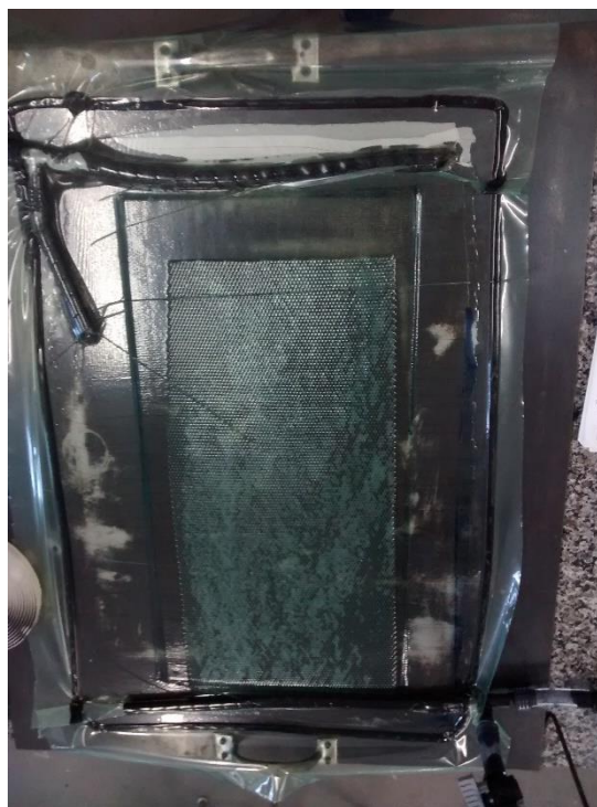
Figura 12 - Resina infundida no molde pelo processo VARTM. Fonte: autor (2015)
