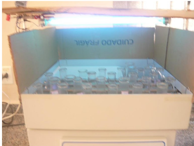
Figura 14: Frascos utilizados nos experimentos de processo Foto-Fenton
