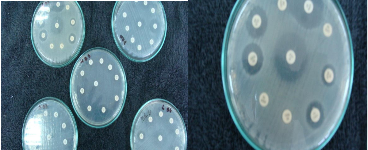
Figura 15 – Halo de inibição de crescimento de bactérias heterotróficas formado ao redor dos discos de difusão de antibióticos
