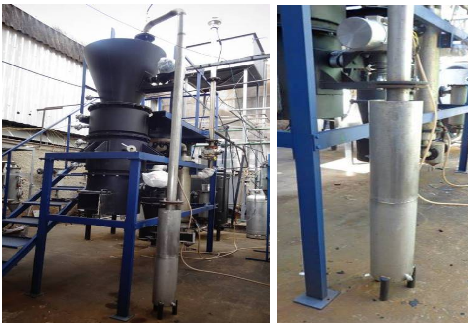
Figura 40. Sistema de amortecimento de sobrecarga do sistema
