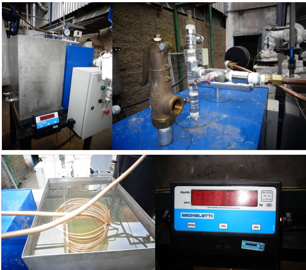
Figura 38. Calibração da válvula de regulação da vazão de vapor
