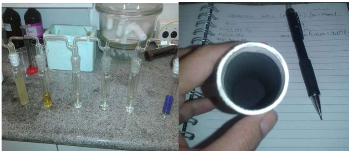
Figura 67. Impingers e filtro após análise de alcatrão utilizando mistura ar+ vapor
