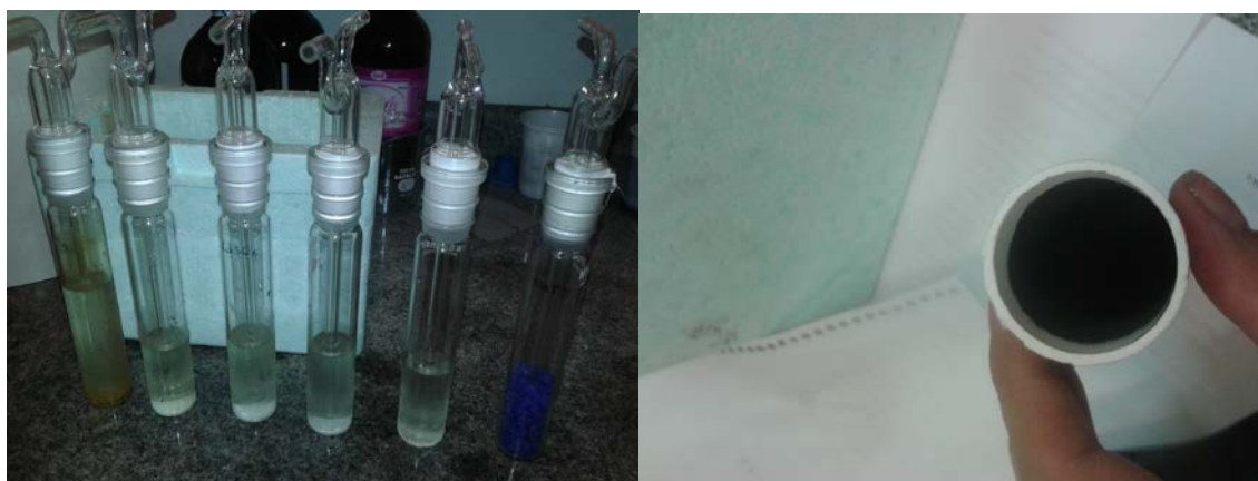
Figura 68. Impingers e filtro após análise de alcatrão utilizando mistura vapor+ oxigênio
