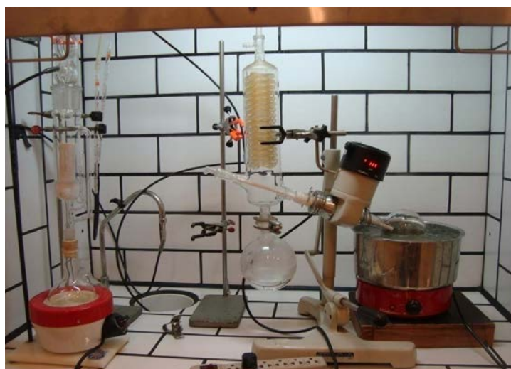
Figura 44. Sistema de extração de soxlet e evaporação do alcatrão
