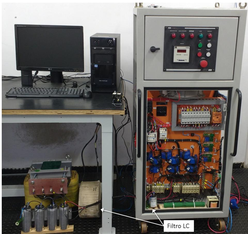
Figura 6.16: Protótipo Filtro Híbrido.
