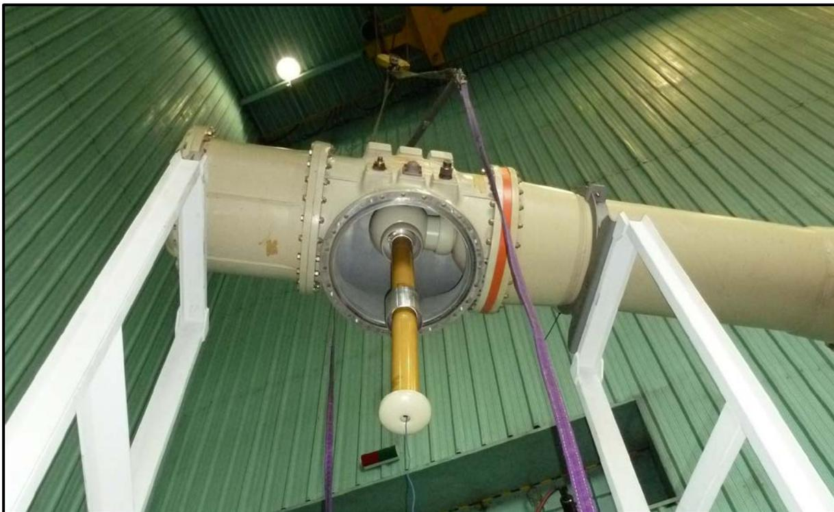
Figura 32 – Detalhe da montagem de capacitores na posição do transformador.
