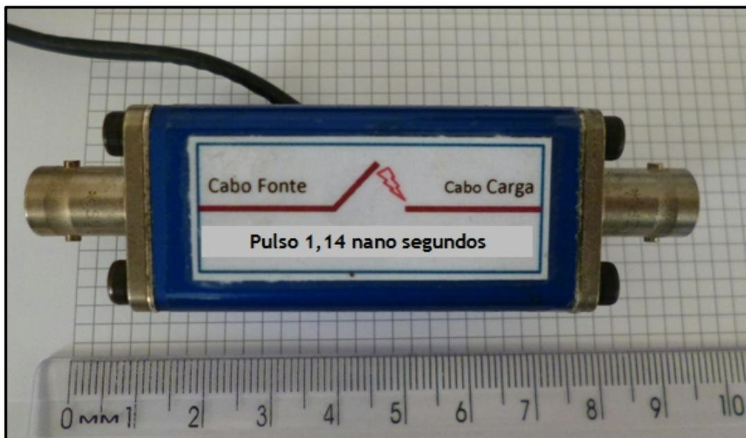
Figura 25 – Gerador de pulsos repetitivos com 1,14 nanosegundos tempo de subida.
