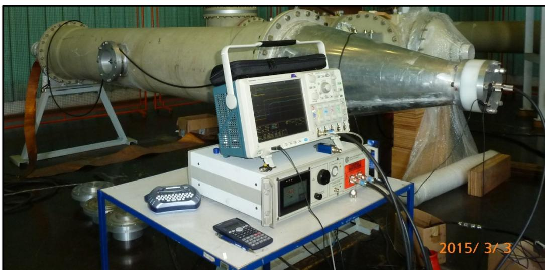
Figura 36 – Célula de teste montada para validação da resposta em frequência do sensor.
