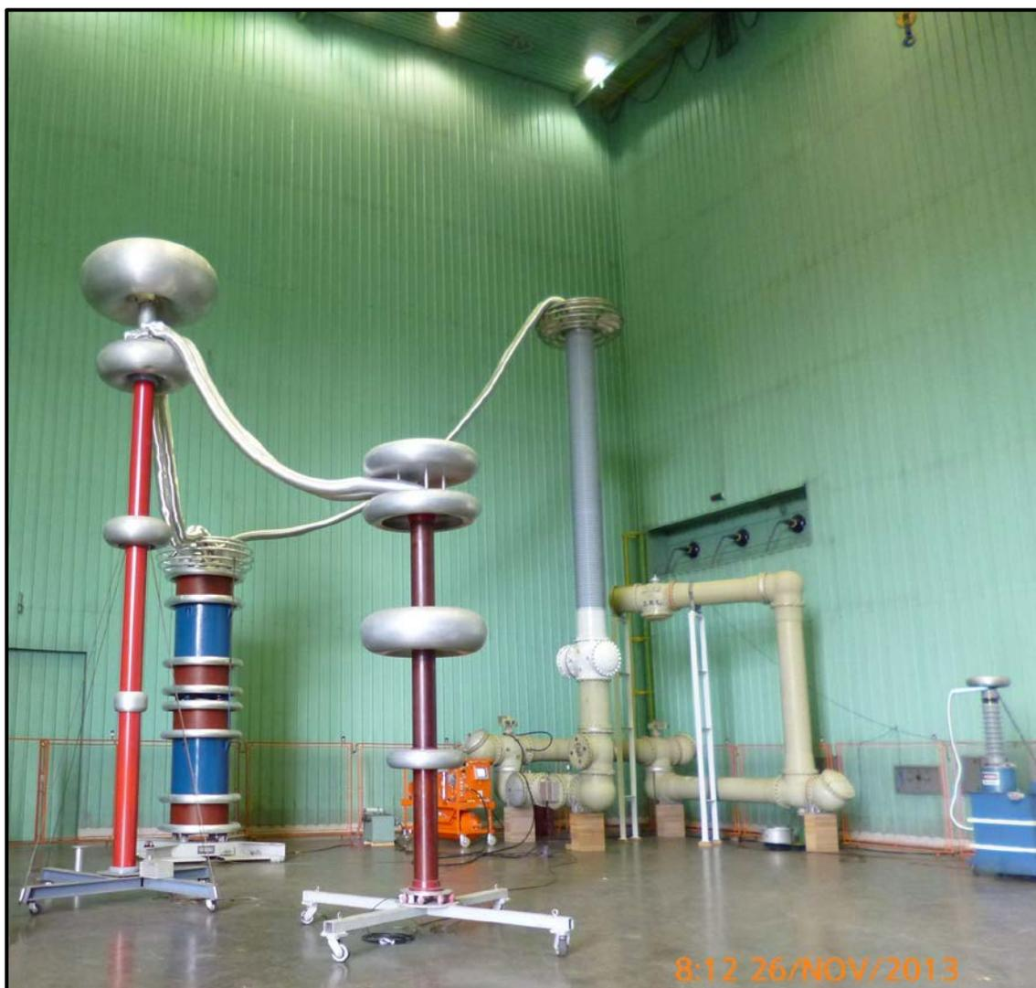
Figura 30 – Vista da montagem do trecho de subestação de 500 kV na sala de ensaios do Laboratório de Alta Tensão dos Institutos Lactec.
