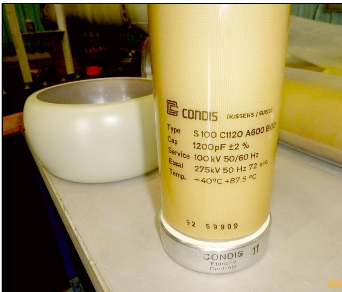
Figura 31 – Capacitor 1200 pF x 100 kV, original da câmara de extinção do disjuntor.
