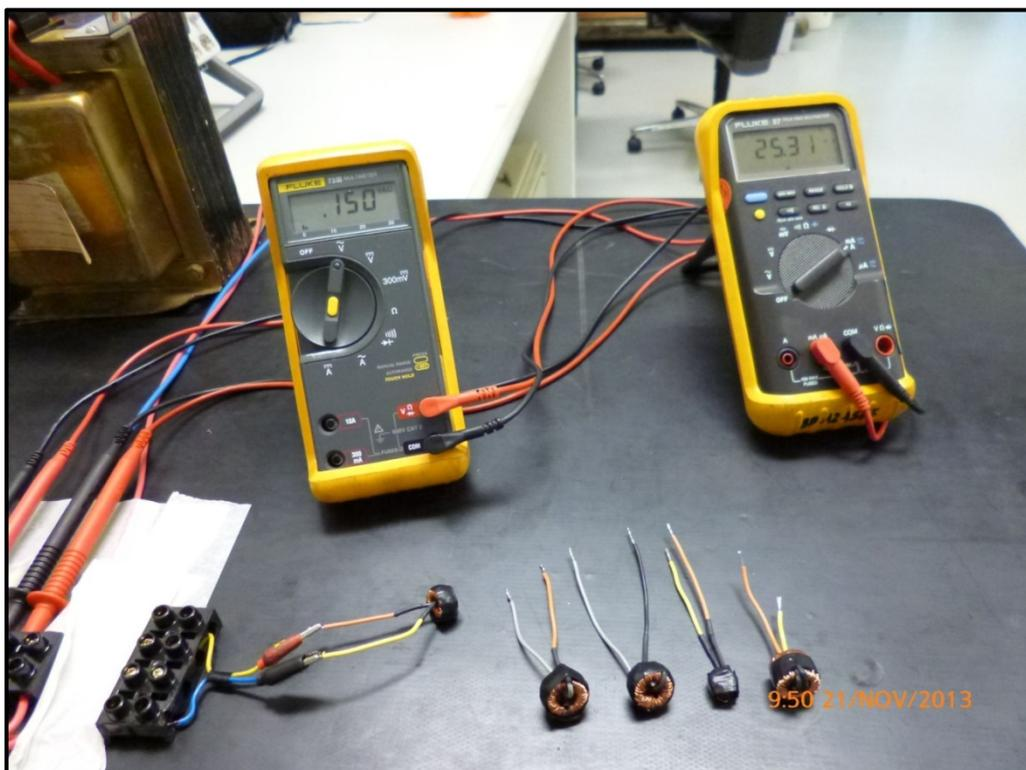
Figura 27 – Montagem para levantamento da curva de saturação dos cinco atenuadores.
