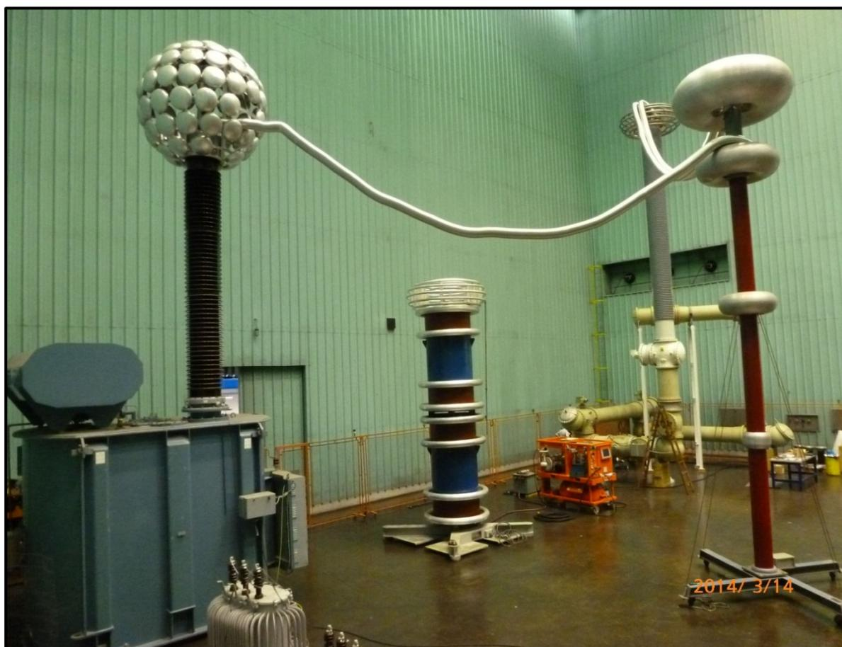
Figura 38 – Conexões externas em 500 kV, do transformador elevador ao divisor capacitivo e deste até a bucha Ar/SF<sub>6</sub>, interface para energização dos barramentos isolados em SF<sub>6</sub>.
