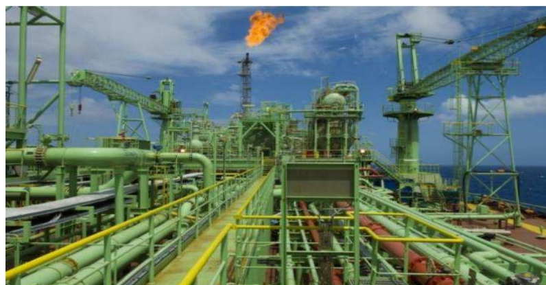
Figura 2.5 Sistema de processamento de óleo e gás natural, com flare em funcionamento. Adaptado de (OLIVEIRA, 2013).
