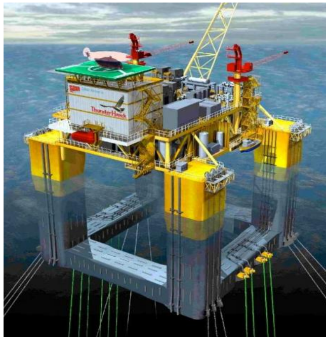
Figura 2.3 Imagem de projeto de plataforma semi-submersível. Adaptado de (FALTINSEN, 1998).
