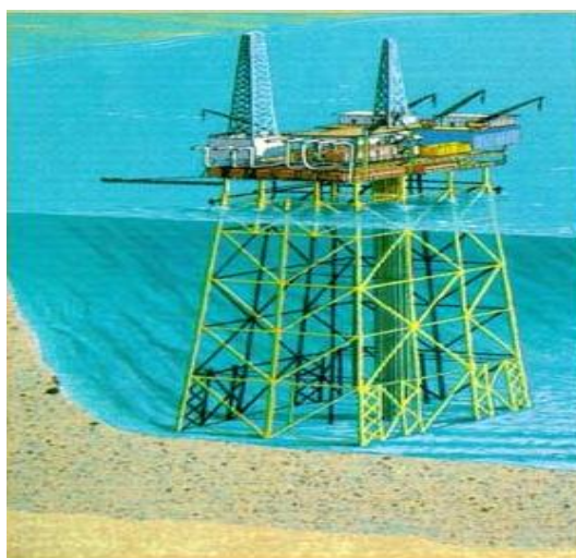
Figura 2.1 Plataforma fixa Adaptado de (Petrobras, 2011).
