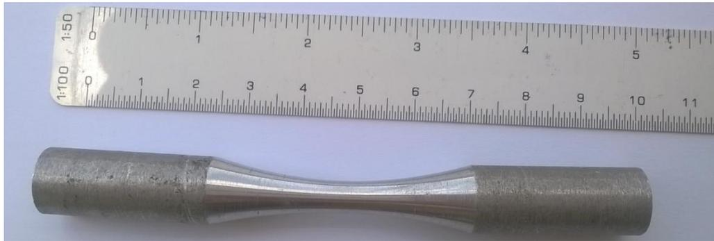
**Figura 40 - Corpo de prova utilizado para teste de fadiga**
