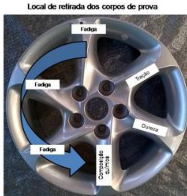
Sentido de retirada dos corpos de prova tendo como referência o furo de válvula
