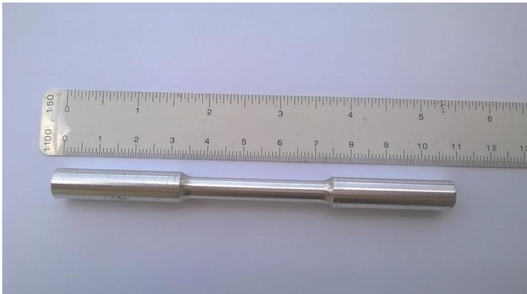
**Figura 38 - Modelo do corpo de prova utilizada**
