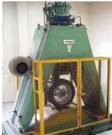
**Figura 15 - Equipamento utilizado para ensaio de fadiga radial**
