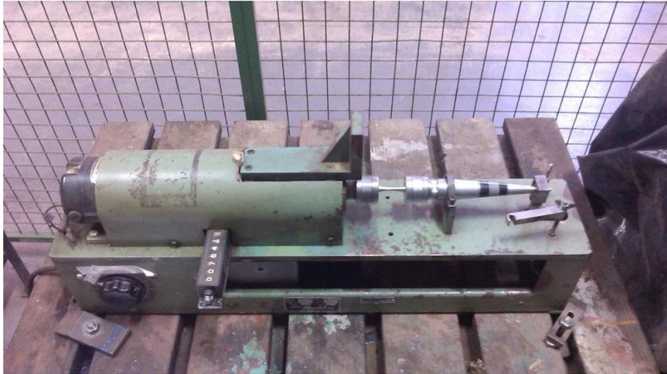
**Figura 43 - Equipamento utilizado para realização dos ensaios de fadiga**
