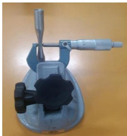
**Figura 41 - Suporte para fixação do corpo de prova para medição utilizando o micrômetro**
