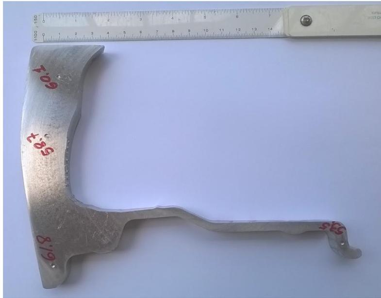
Figura 39 - Vista em corte de uma roda para análise de dureza
