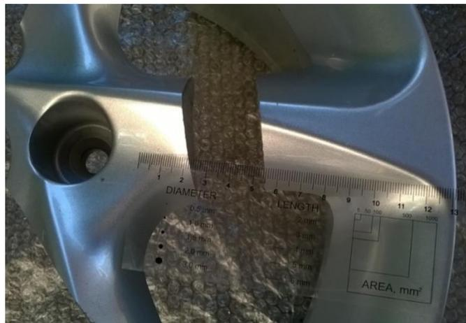
**Figura 32 - Local de retirada do corpo de prova para análise química**
