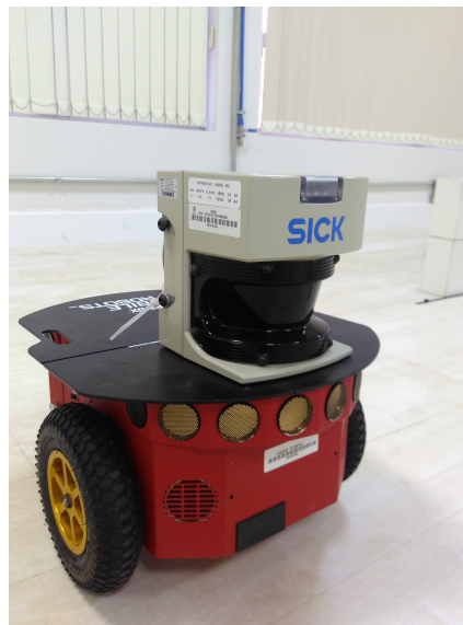
Figura 4.1.1 – Pioneer 3DX com laserscan SICK LMS 291 instalado sobre a plataforma do robô móvel.
