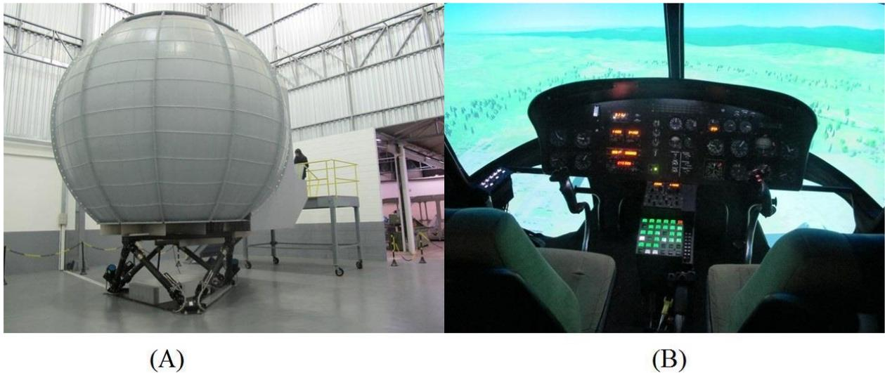
Figura 1.2 - Simulador Esquilo Fennec CIAvEx. (A) Atuadores do sistema de percepção de forças da aeronave. (B) Sistema visual e cabine do helicóptero (DEFESA AÉREA & NAVAL, 2012).
