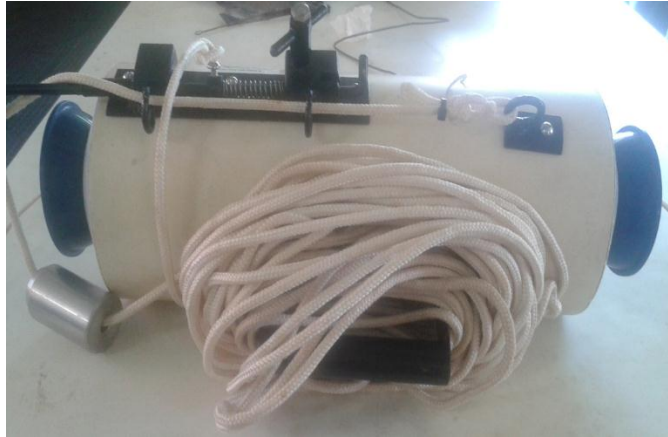
Figura 3.3: Foto da garrafa de van Dorn utilizada nas coletas de águas superficiais
