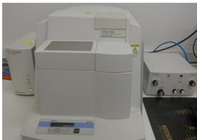
**Figura 30** – Foto do equipamento de DSC Shimadzu modelo DSC 60.
