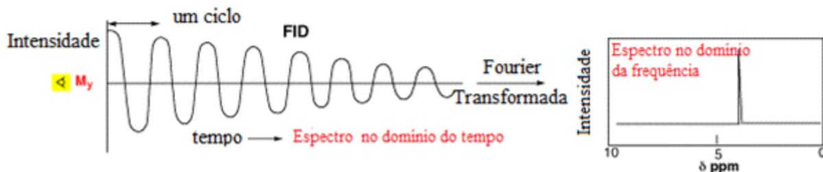
**Figura 25** – Esquema da transposição gráfica obtida através da transformada de Fourier.
