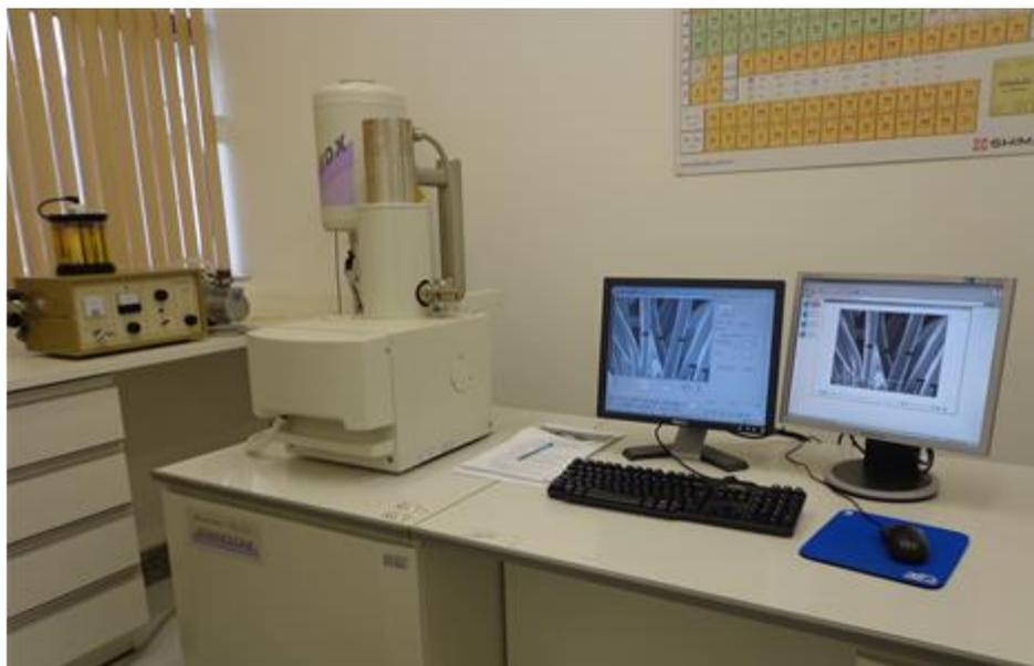
**Figura 28** – Foto do equipamento MEV Shimadzu modelo SS-550.
