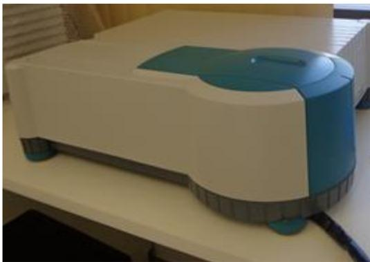
**Figura 27** – Foto do espectrofotômetro UV –Vis Varian, modelo Cary 50.
