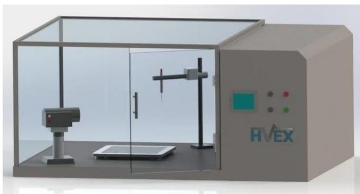
**Figura 18** – Foto do equipamento utilizado no processo de eletrofiação do conjugado  $\text{PGA}_{g4}$ -c-HLP
