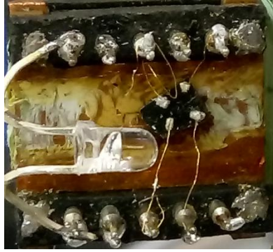
Figura 4.7: Foto do arranjo experimental utilizado para as medições de efeito Hall e fotocondutividade.
