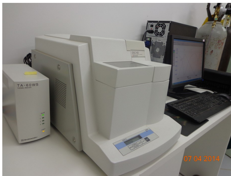
Figura 53 - Ilustra o calorímetro exploratório diferencial do Laboratório de Análise Térmica da UNIFEI.
