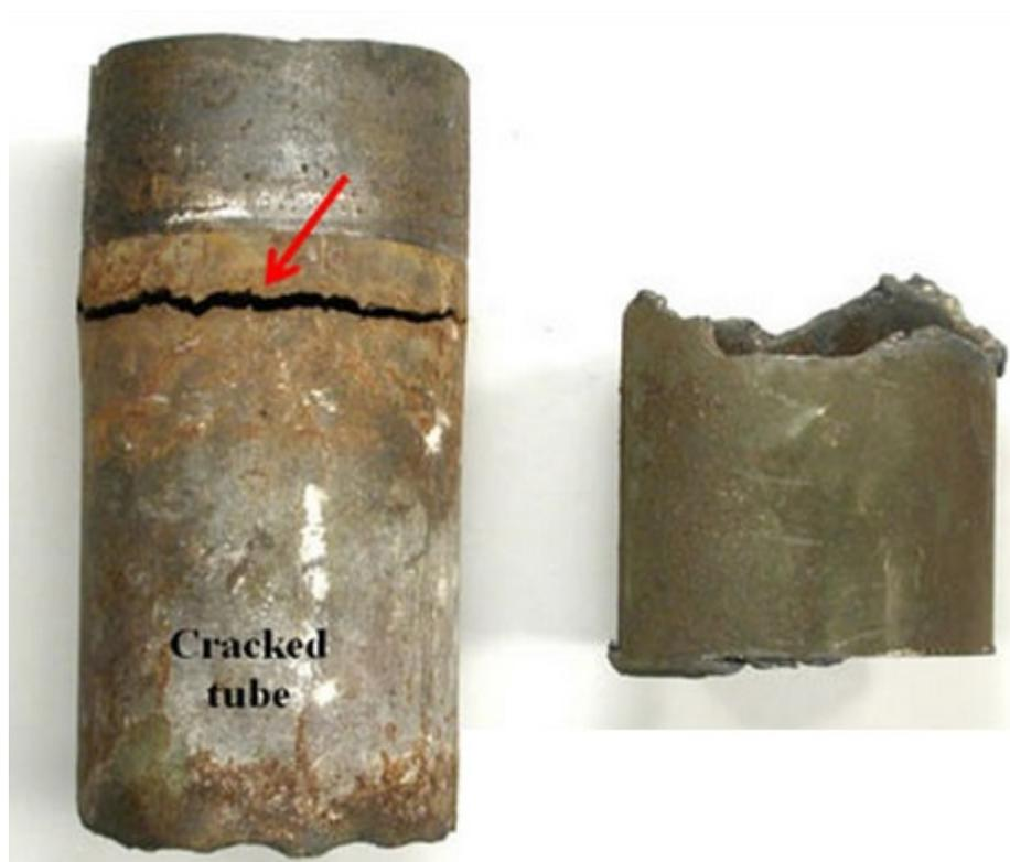
Figura 2: Corrosão sob tensão em estado crítico de um tubo de aço inoxidável AISI 316Ti (TECHNOLOGIES, 2011).
