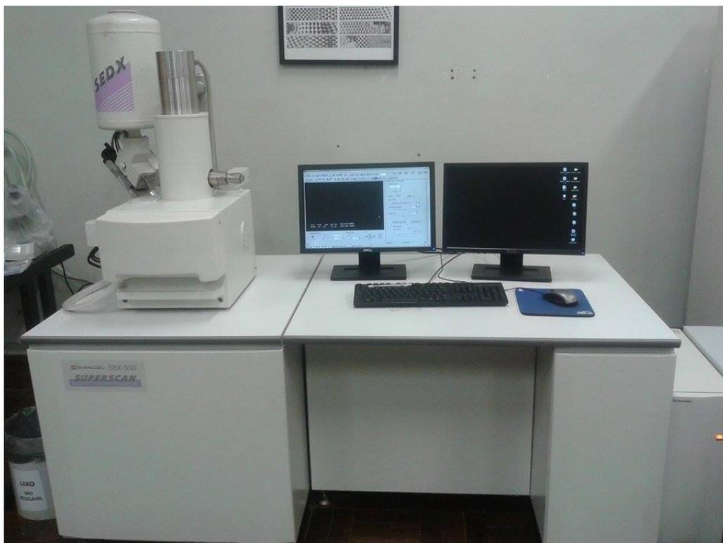
Figura 54: Microscópio Eletrônico de Varredura (MEV). Centro Federal de Educação Tecnológica de Minas Gerais - CEFET/MG.
