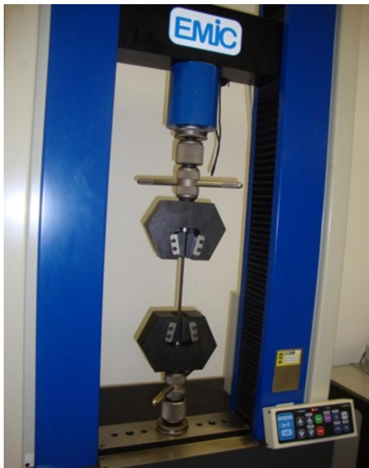
Figura 49: Máquina utilizada para ensaios de tração.
