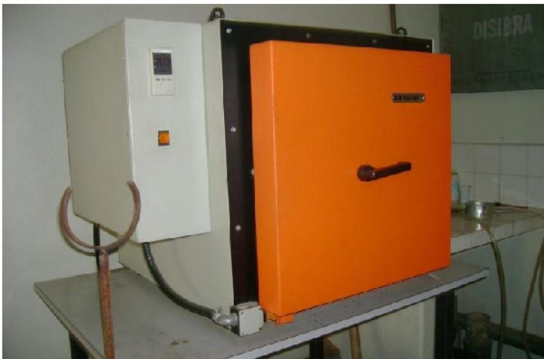
Figura 57: Forno mufla usado nos tratamentos térmicos de envelhecimento.
