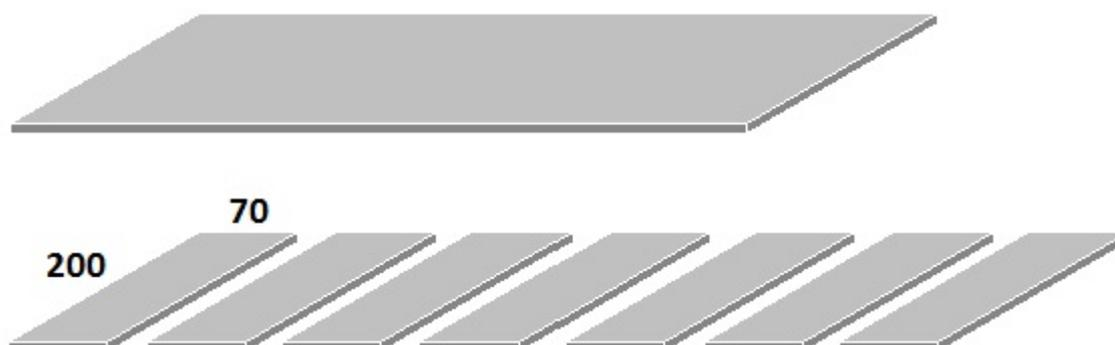
Figura 45: Dimensões das chapas cortadas em milímetros.
