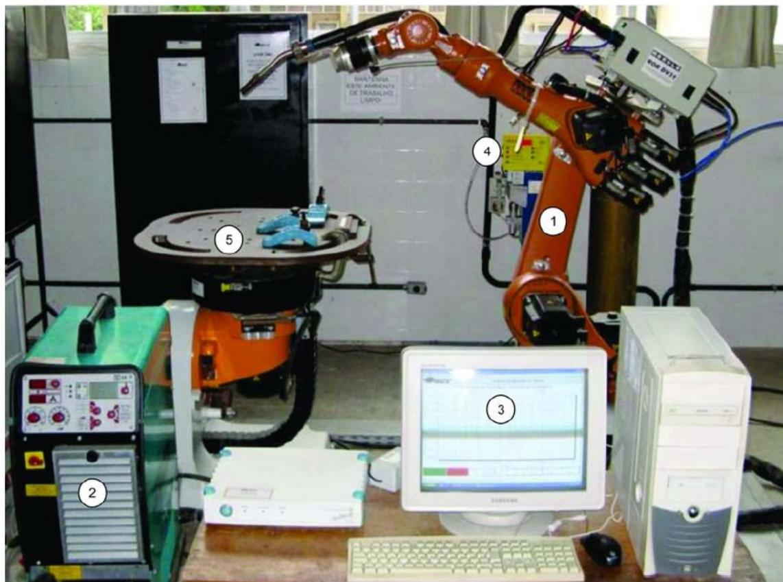
Figura 47: Equipamentos utilizados nas soldagens: (1) robô industrial com tocha e alimentador de arame-eletrodo, (2) fonte eletrônica multiprocesso, (3) Sistema de aquisição, (4) Medidor de Valim, (5) Mesa de trabalho.
