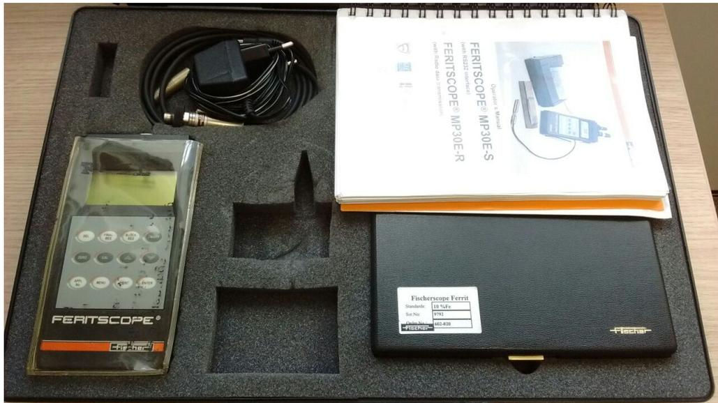
Figura 56: Ferritoscópio utilizado. LPTS - Universidade Federal do Ceará - UFC.
