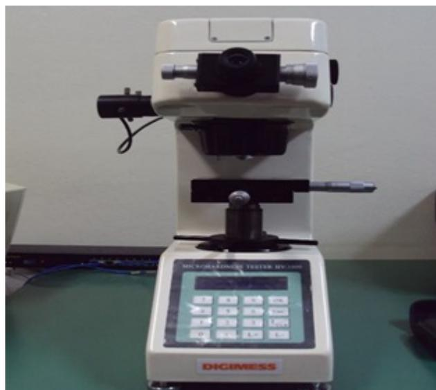
Figura 51: Microdurômetro usado nas medições.
