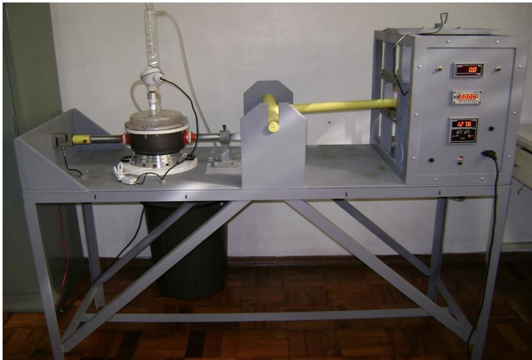
Figura 58: Banco de teste de corrosão sob tensão em funcionamento.
