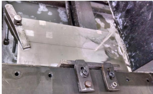
Figura 4.6 – Corte da Placa 6.3 por eletroerosão
