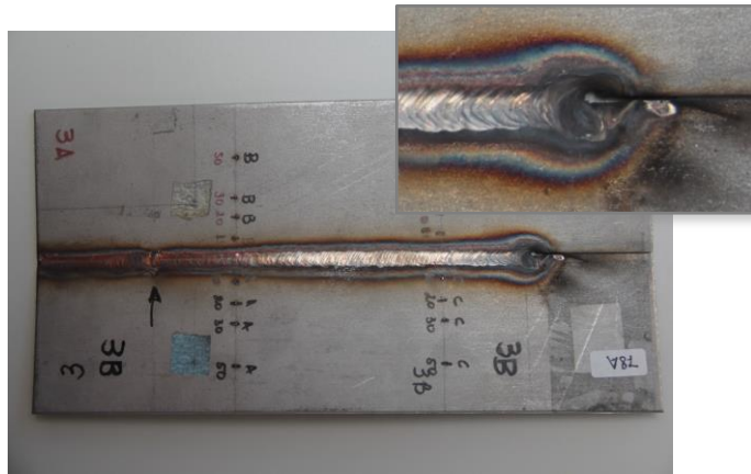
Figura 4.8 – Solda interrompida por excesso de calor
