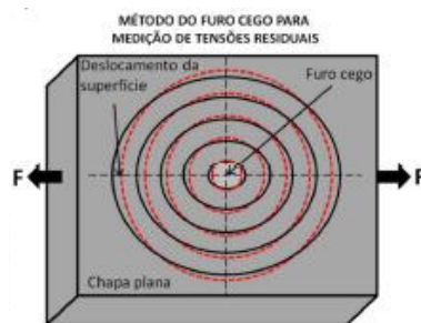
Figura B.2 – Método do furo cego. Fonte: Blödorn (2015)
