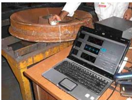
Figura B.7 – Medição de tensão residual pelo método do ruído magnético de Barkhausen . Fonte: Ladin/USP (2011).
