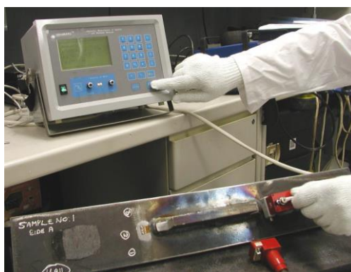
Figura B.6 – Medição da tensão residual de um componente soldado utilizando um dispositivo de ultrassom. Fonte: Kudryavtsev & Kleiman (2012).
