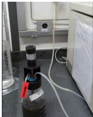
Figura 4.13a – Aplicação de nitrogênio no frasco com lodo UASB.
