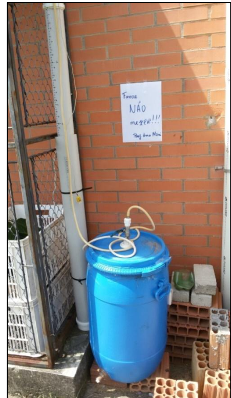
Figura 4.6b - Célula experimental (gasômetro + biodigestor)
