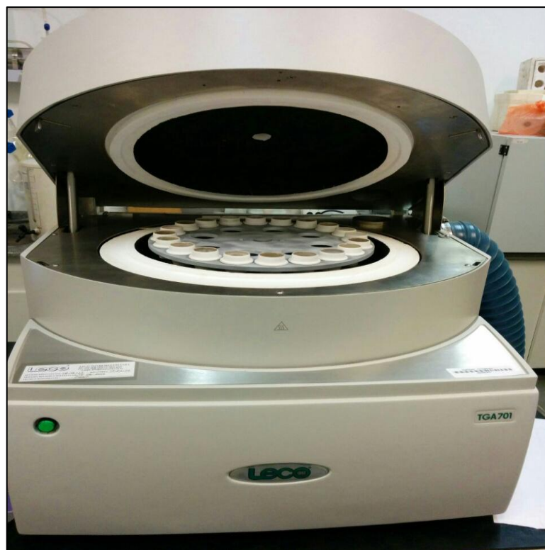
Figura 4.2 – Teste das amostras de lodo no TGA.
