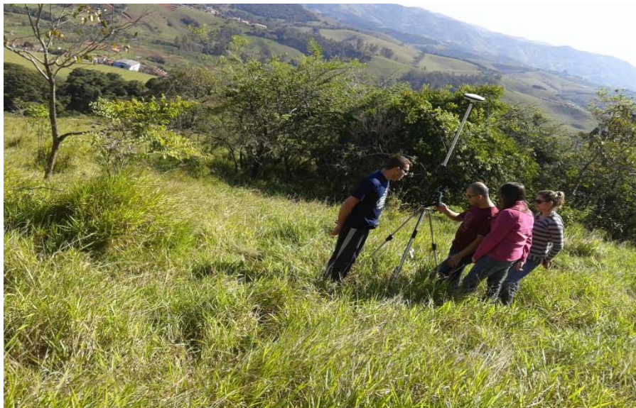
Figura 14 - DGPS base sendo configurado na base fixa.
