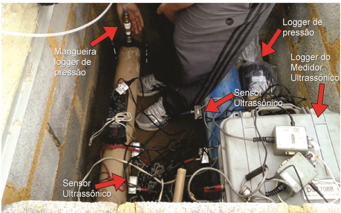
Figura 21 – Dois medidores de vazão ultrassônicos e dois medidores de pressão em campo (reservatório R3), devidamente protegido contra respingos de água.
