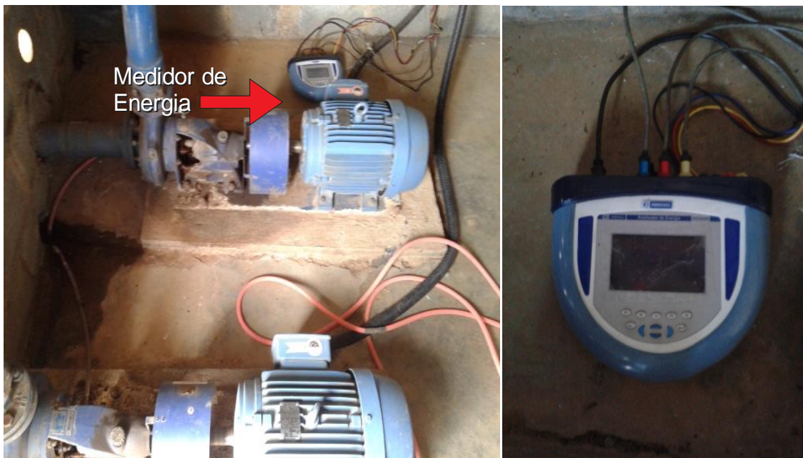
Figura 22 - Analisador de energia da empresa contratada, já em campo (R3).
