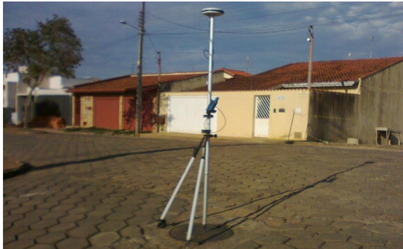
Figura 30 - Coleta de dados geográficos nos registros que controlam a vazão para o bairro Vale das Montanhas.
