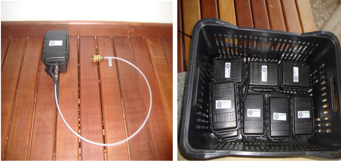
Figura 41 - Medidores de pressão retirados das residências.
