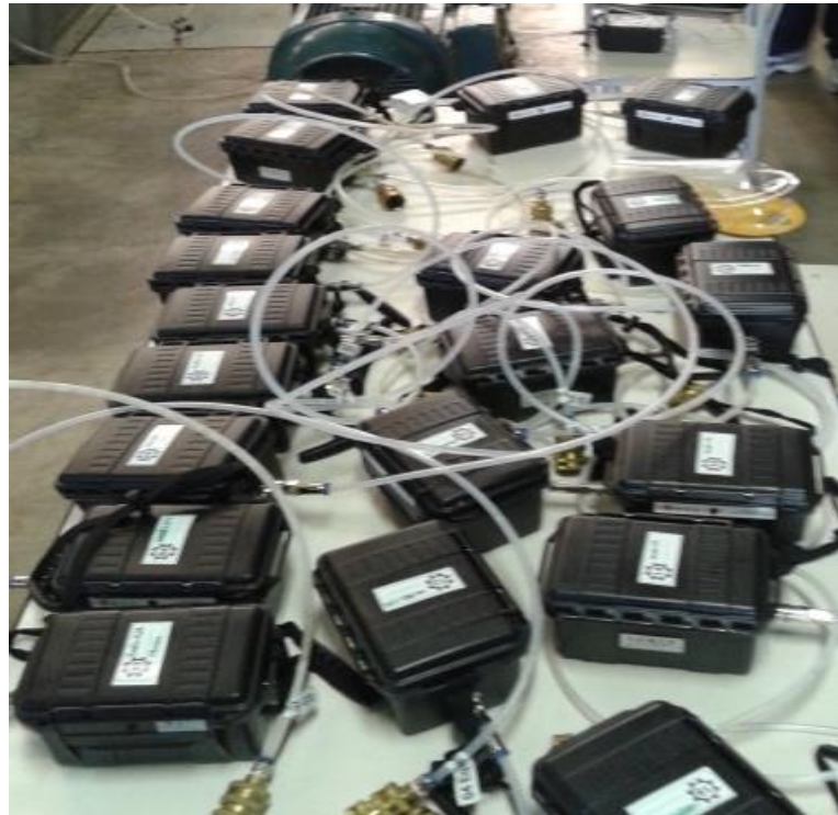
Figura 19 - Medidores de pressão, sendo testados no laboratório da UNIFEI.
