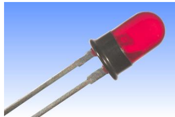
Figura 26 – LED DIP desenvolvido em 1962 por Nick Holonyak Fonte: http://www.lampstech.co.uk/Spec%20Sheets/LED%20HP%205082-4403.htm
