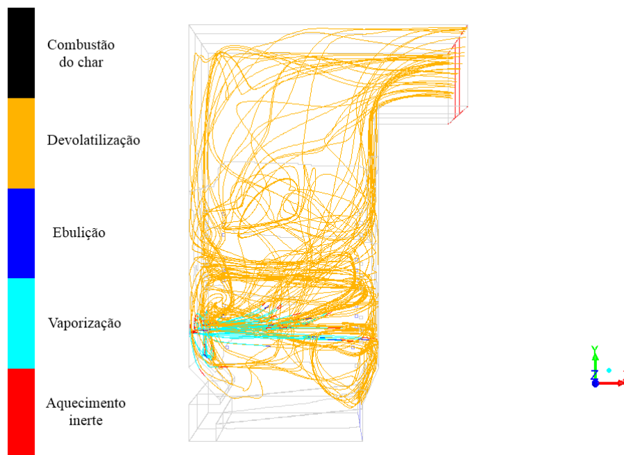
Figura 35 – Trajetórias das partículas de combustível da injeção 00 coloridas pelos processos de transferência de massa e calor
