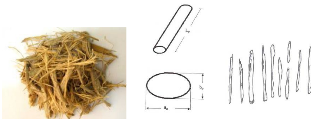
Figura 3 – Bagaço de cana - Fibra. (a) foto, (b) características geométricas e (c) esquema. Fonte: Sosa Arnao (2007)
