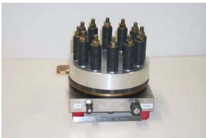
Figura 2-22. Fotografia do eletrolisador PEM feito pela PES, adaptada de [38].
