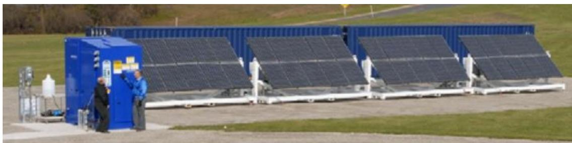
Figura 2-16. Sistema de painéis fotovoltaicos para a geração de hidrogênio a elevada pressão, adaptada de [32].
