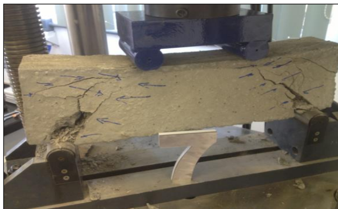
Figura 33 - Corpo de prova número 7, viga com armação soldada.
