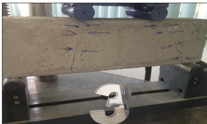
Figura 31 - Corpo de prova número 3, viga com armação amarrada.
