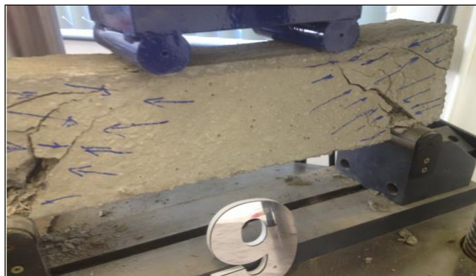
Figura 35 - Corpo de prova número 9, viga com armação soldada.
