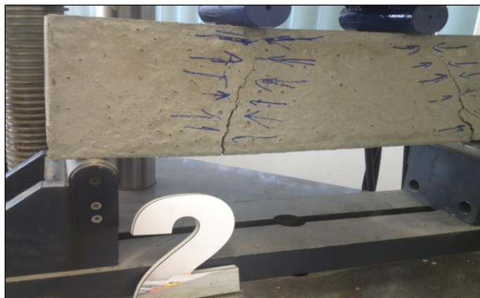
Figura 30 - Corpo de prova número 2, viga com armação amarrada.
