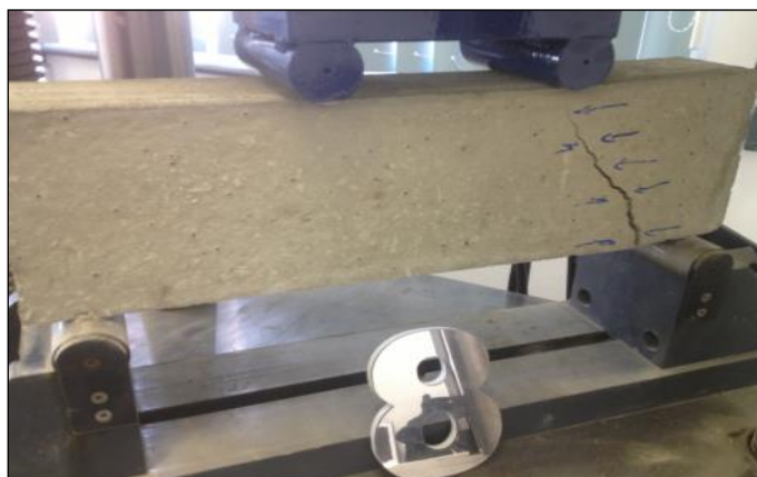
Figura 34 - Corpo de prova número 8, viga com armação soldada.
