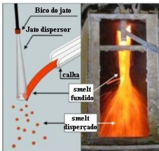
Figura 2.26 – Bico dispersor de smelt
