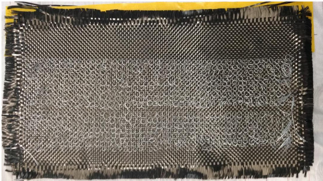
Figura 4.7 - Loops na superfície inferior da preforma manufaturada para os ensaios em modo II.
