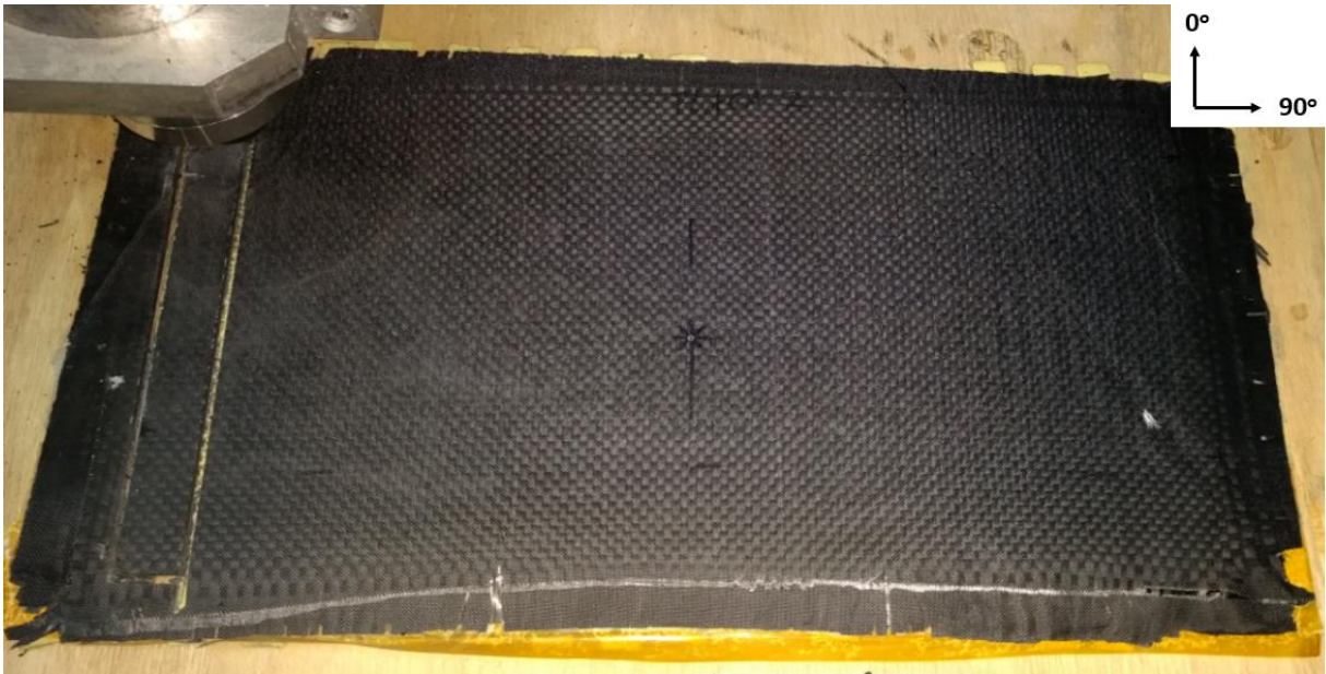
Figura 3.23 - Usinagem dos corpos de prova para ensaios em modo II.
