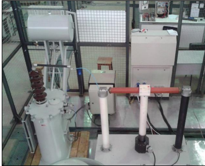
Figura 9 – Fonte de alimentação do Gerador de Impulsos LAT-EFEI, composta por um variador de tensão, transformador elevador e o módulo do diodo. Fonte: o autor (2016).
