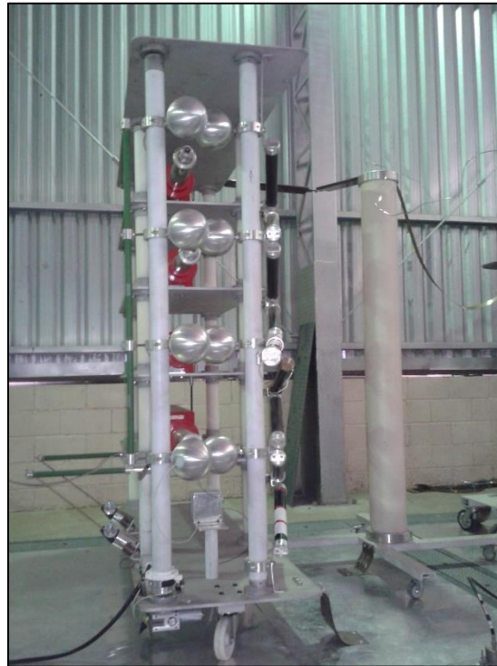
Figura 10 – Gerador de impulsos atmosféricos de tensão LAT-EFEI. Fonte: o autor (2016).
