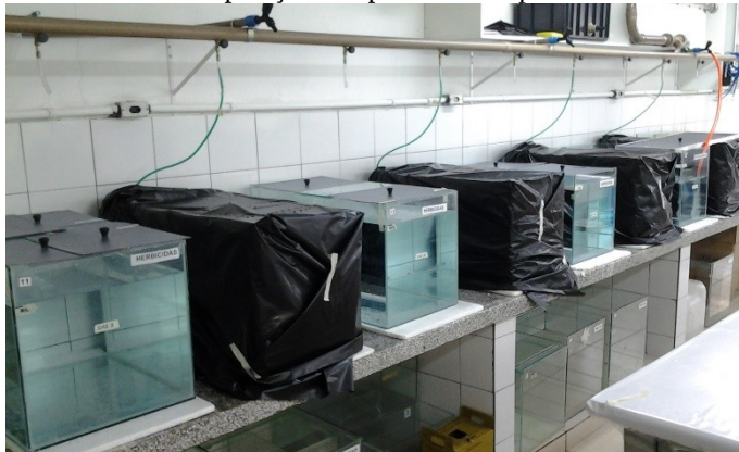
Figura 18 - Sistema de exposição dos peixes A. altiparanae ao Imidacloprido.
