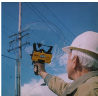
Figura 2.1 – Utilização em campo do detector de ultrassom
