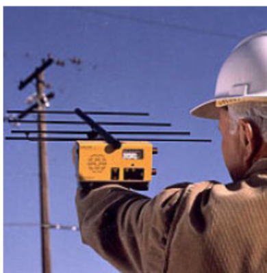
Figura 2.3 – Utilização em campo do detector de RF
