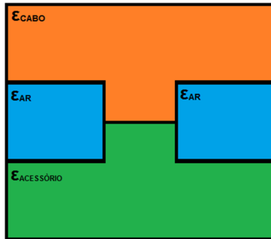
Figura 1.2 - Desenho de dielétricos no sistema cabo/acessório.
