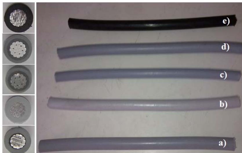
Figura 2.4 - Amostras de cabos ensaiados.
