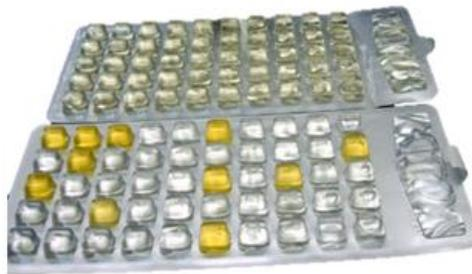
**Figura 27** – Cartelas de *colilert* utilizadas na análise de coliformes termotolerantes.
