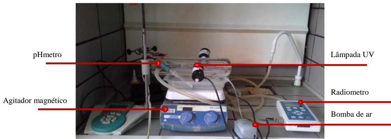
**Figura 28** – Reator utilizado para reação de degradação foto-Fenton.
