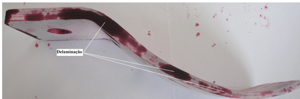
Figura 4.39: Componente da prótese após realização do LP, evidenciando delaminação nas regiões de curvatura.
