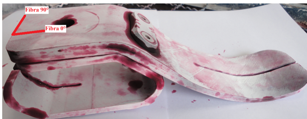
Figura 4.29: Eixos de orientação das fibras na prótese.
