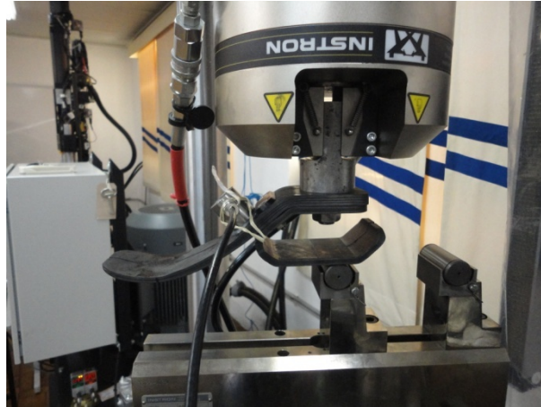
Figura 3.13: Ensaio de compressão na região do calcanhar da prótese transtibial.
