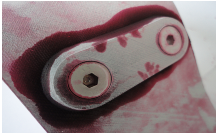
Figura 4.41: Falhas no componente de junção em ABS.
