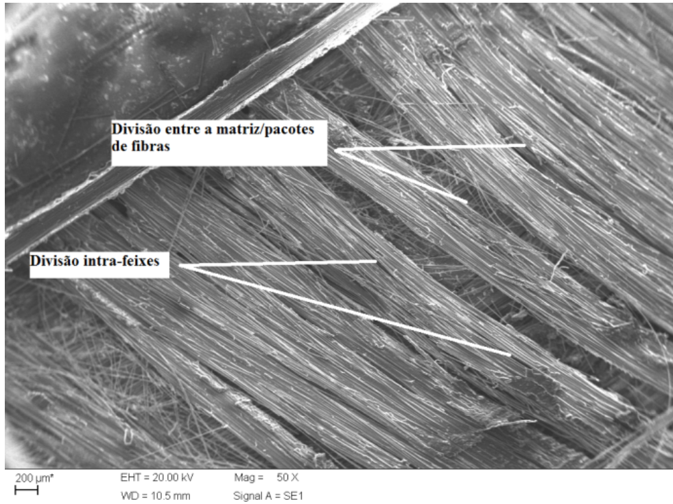
Figura 4.18: Micrografia das amostras FQ obtida por MEV evidenciando a divisão intra-feixes e divisão entre a resina e pacotes de fibras.
