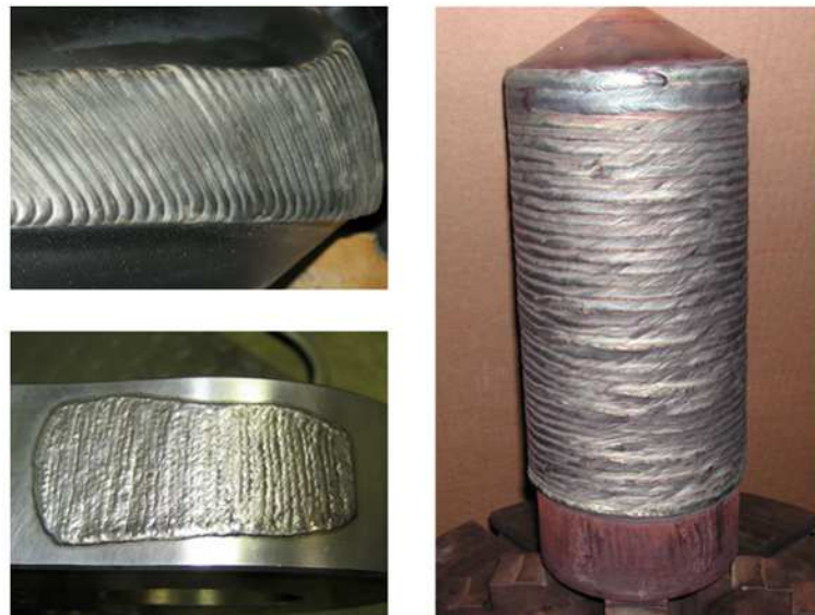
Figura 4.2 – Exemplos de camadas de revestimento
