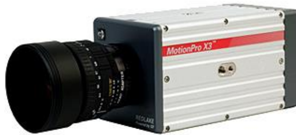
Figura 3.8. Filmadora de alta velocidade IDT, modelo Motion Pro X3, utilizada para filmagens rápidas do escoamento sincronizadas com o ultrassom.
