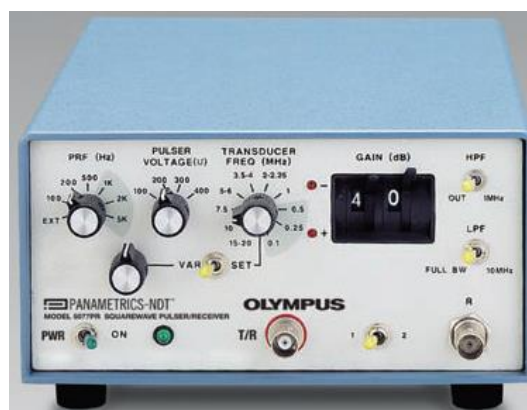
Figura 3.7. Gerador de pulsos Panametrics , modelo 5077PR, utilizado para gerar os pulsos no sensor a 0^\circ .
