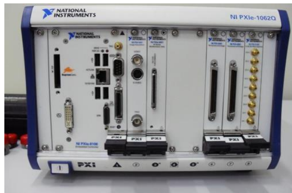
Figura 3.6. PXI modelo 1062Q utilizado para aquisição dos dados.
