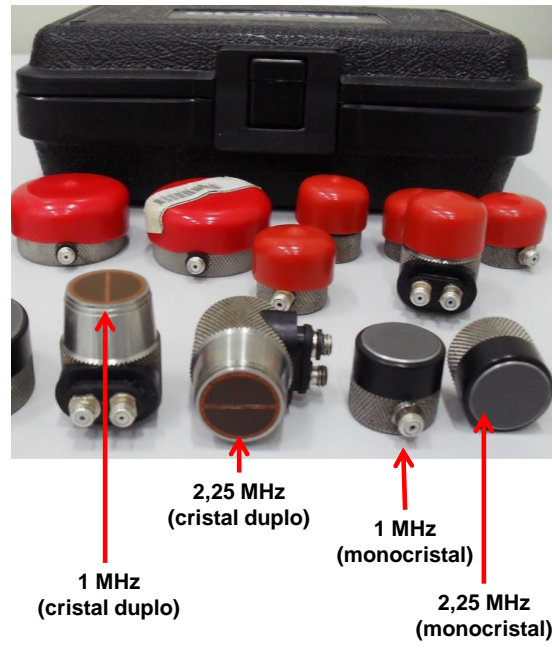
Figura 3.4. Fotografia dos transdutores ultrassônicos utilizados nos testes experimentais.
