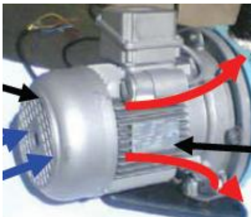
Figura 4.3 – Passagem de ar através da carcaça
