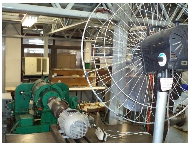
Figura 6.27 – Ensaio no motor de 3 cv com ventilador
