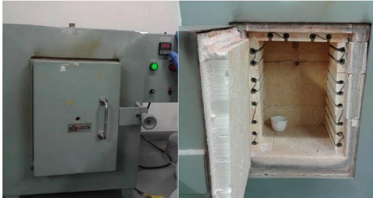
Figura 4.9 – Forno para calcinação.
