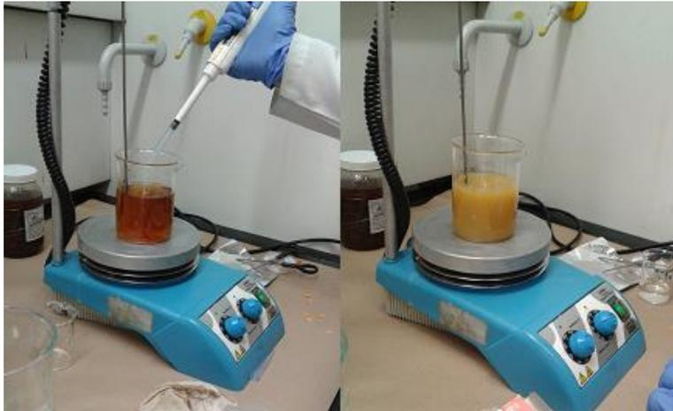
Figura 4.1 - Aquecimento do glicerol e adição de  $\text{H}_2\text{SO}_4$
