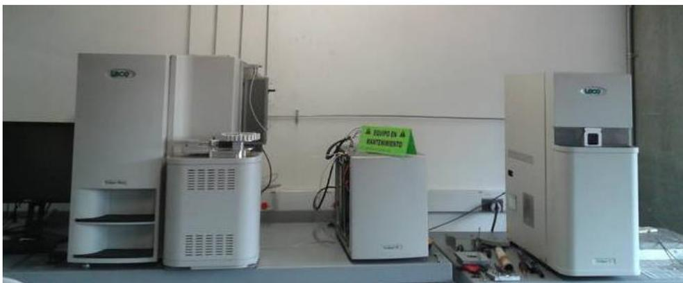
Figura 4.12 – Equipamento (Leco – TRU Spec-Micro) para análise elementar.
