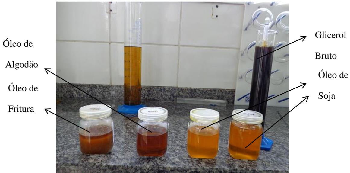
Figura 6.6 - Matérias primas utilizadas para a produção do biodiesel e o glicerol bruto como resíduo.
