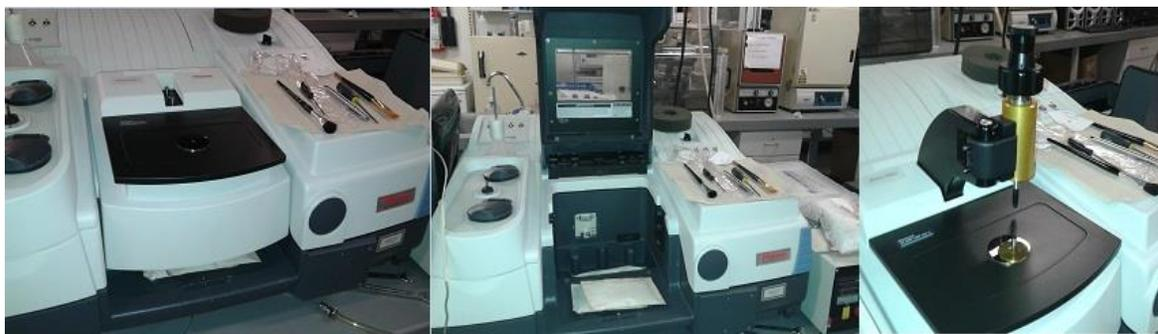
Figura 4.15 - Equipamento (Thermo Scientif) utilizado para análise IR-ATR.
