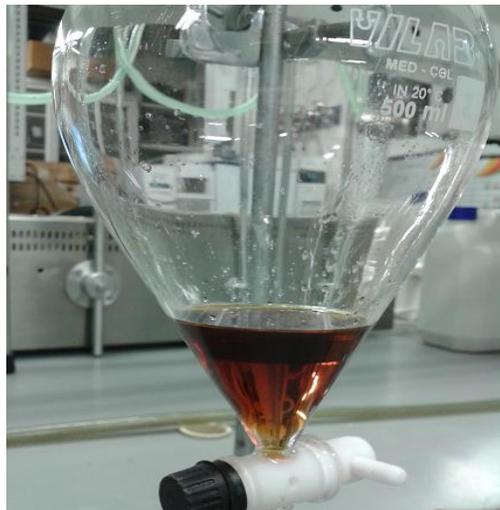
Figura 4.6- Glicerol neutralizado com duas fases, glicerol mais puro na parte inferior e óleos mais densos na parte superior.
