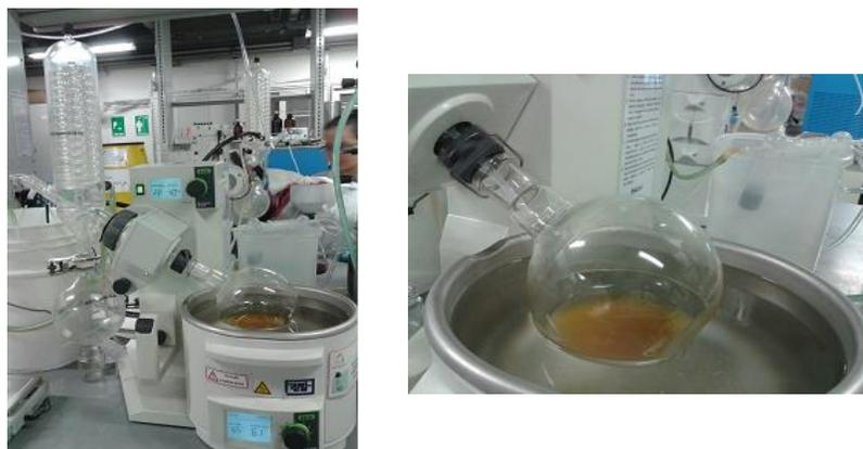
Figura 4.4 – Equipamento (BUCHI Switlerlance) para retirada do metanol do glicerol.
