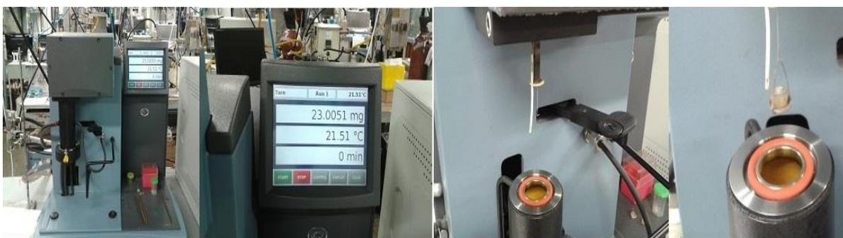
Figura 4.14 - Equipamento (Q500) para análise TGA.
