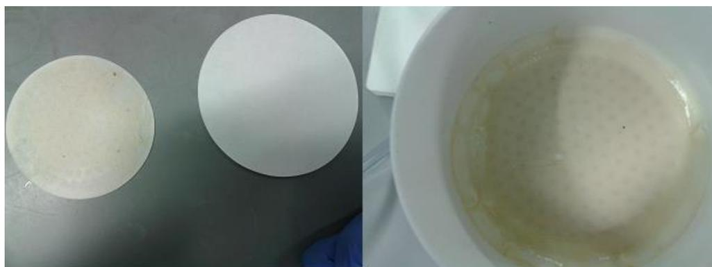
Figura 4.3 - Filtros utilizados para retenção do  $\text{Na}_2\text{SO}_4$
