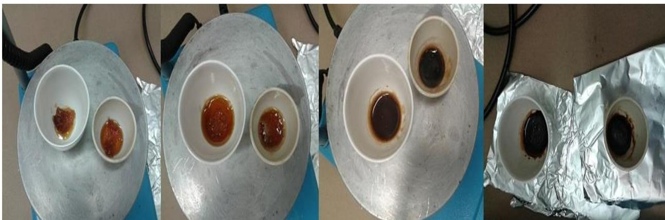
Figura 4.7- Recipientes com amostras de glicerina no equipamento aquecendo até a fundição
