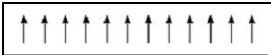
Figura 7: Na ausência de um campo magnético externo, os momentos magnéticos permanentes resultam dos spins emparelhados. Fonte: (CALLISTER, 2007).
