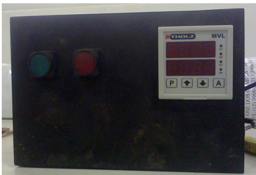
Fotografia C.6 – Controlador de tempo e temperatura.
