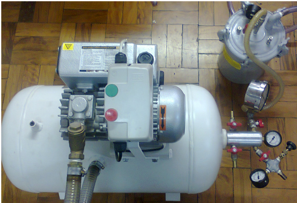
Fotografia C.7 – Bomba de vácuo.
