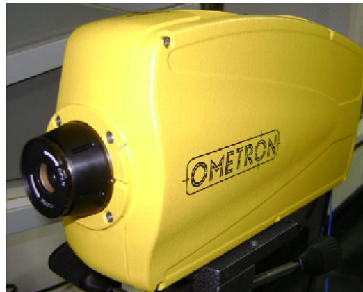
Fotografia C.1 – Vista frontal do vibrômetro laser.
