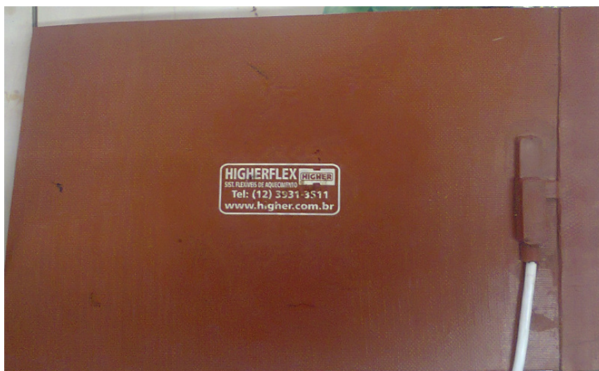
Fotografia C.5 - Manta térmica utilizada.
