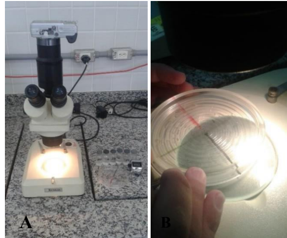
Figura 14 - Contagem do número de esporos. A e B- Visualização no microscópio estereoscópico.
