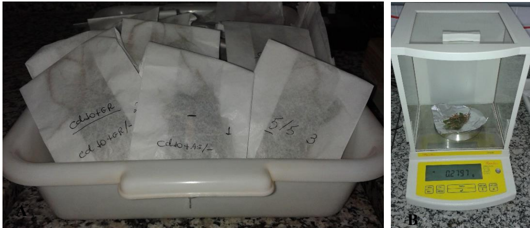
Figura 6 - Acondicionamento e pesagem das amostras. A- Amostras para a pesagem após secagem na estufa. B- Pesagem das amostras na balança analítica.
