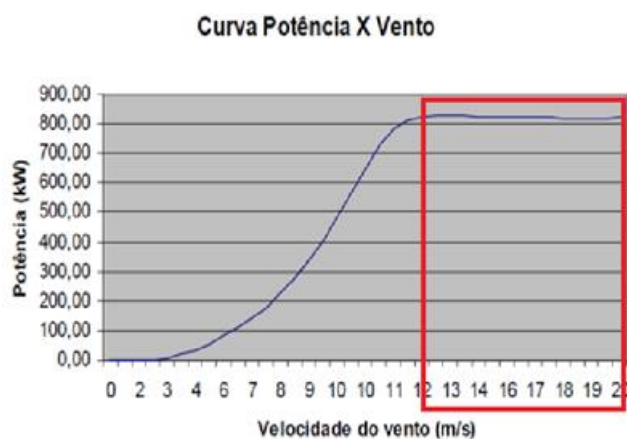
Figura 5.2: Curva potência × vento (região de potência constante).
