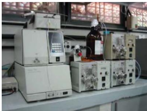
Figura 5.8 Equipamento para GPC da Waters, modelo 510, utilizado nesse trabalho. O equipamento pertence à Petroquímica União-SP/SP.
