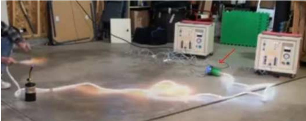
Figura 50: Teste realizado em válvula corta-fogo pela “HHO Gas Technology”.
