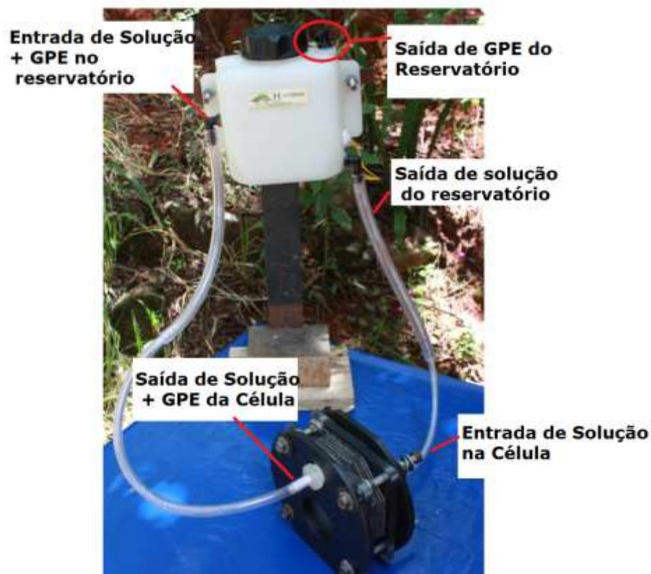
Figura 47: Ilustração de uma “dry cell” ligada ao reservatório (água + eletrólito)
