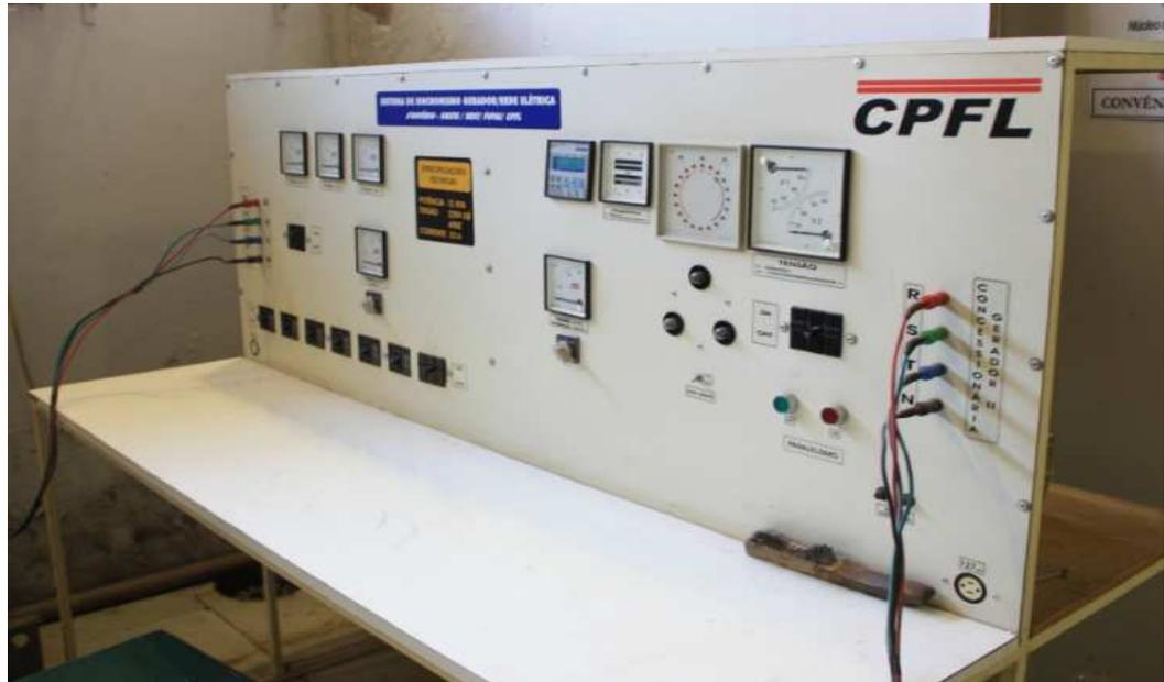
Figura 71: Bancada de ensaios de geradores.
