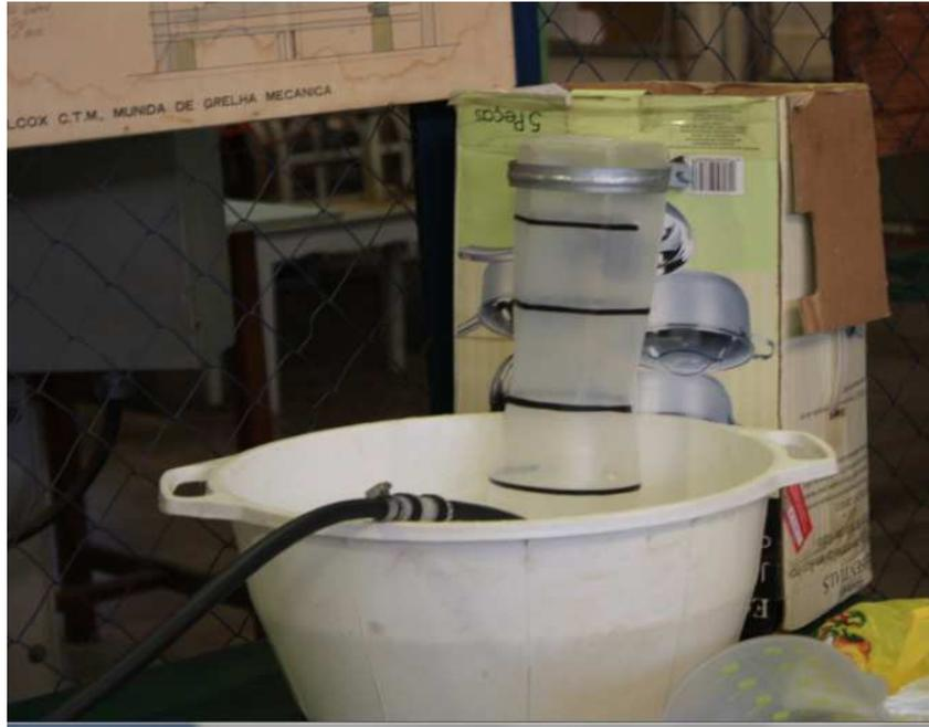
Figura 75: Recipientes utilizados na medição de GPE produzido.
