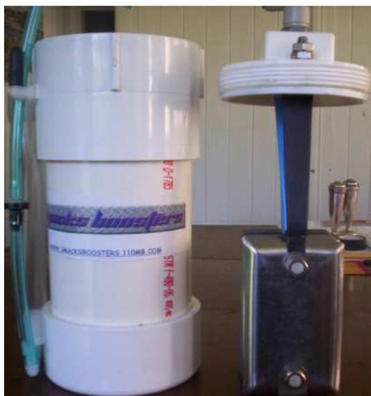
Figura 43: Células de placas paralelas submersas. (Panacea University, 2012)
