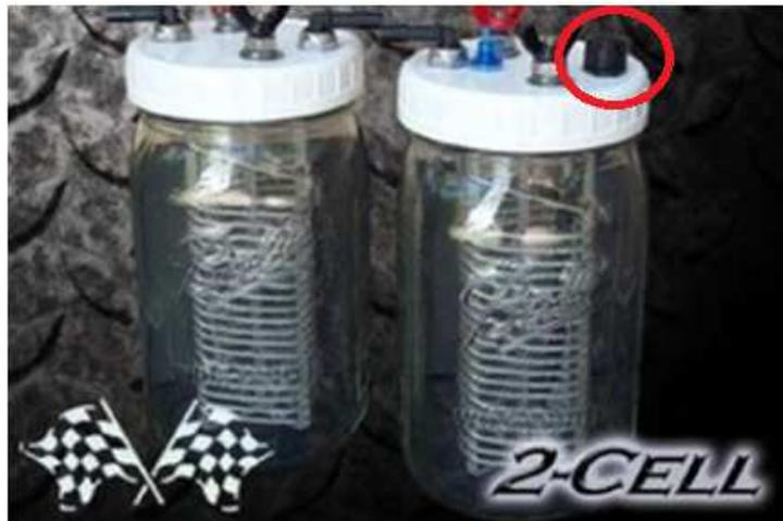
Figura 41: Eletrolisador de arames helicoidais – Detalhe de entrada de ar.
