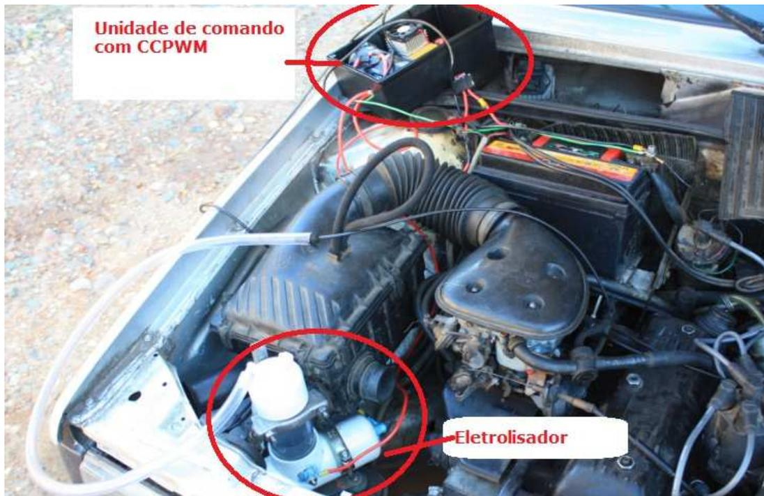
Figura 63: Instalação do sistema de Produção e adição de GPE utilizado
