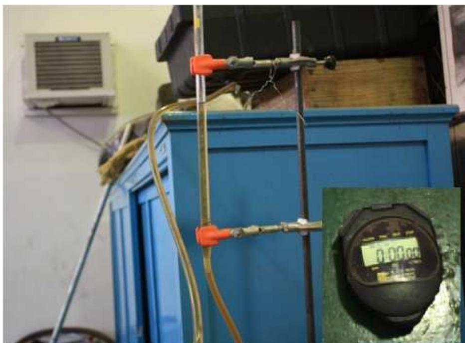
Figura 70: Proveta graduada e cronômetro utilizados para medição de consumo de gasolina.
