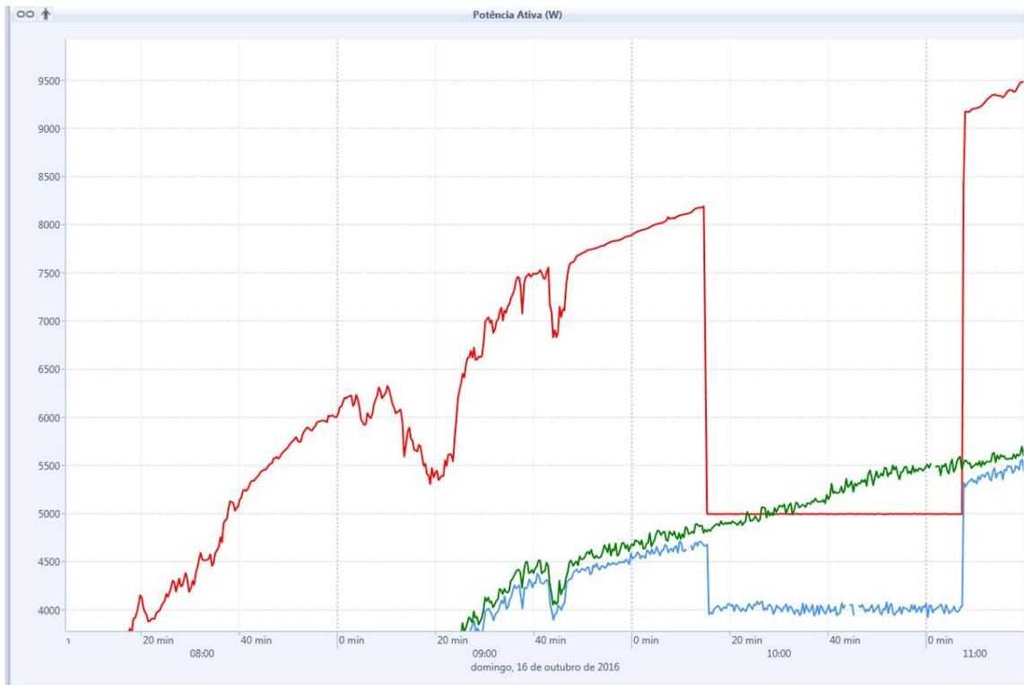
Figura 48: Controle de potência ativa (Potência ativa Inversor 13 (vermelho), Inversor 15 (azul), Inversor 19 (verde))
