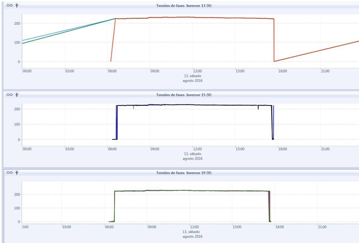
Figura 46: Carregamento das tensões de fases nos três inversores
