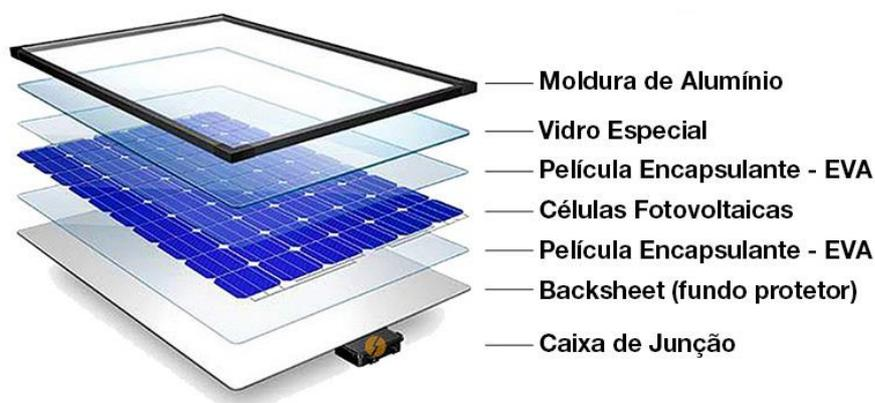
Figura 7: Estrutura de encapsulamento de um módulo fotovoltaico (“Portal Solar”).
