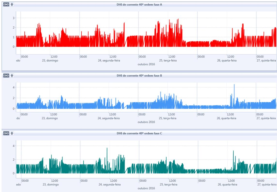
Figura 53: DHI de corrente de 40ª ordem das três fases
