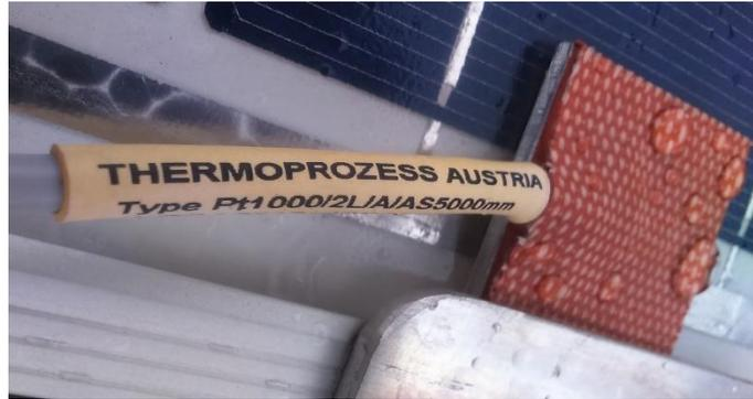
Figura 21: Sensor de temperatura Pt1000
