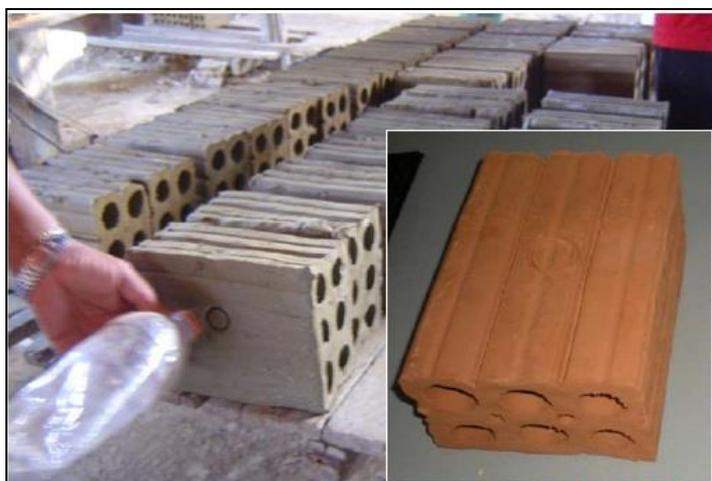
**Figura 55** - Produção tijolo. A figura mostra a peça cru e após a queima.
