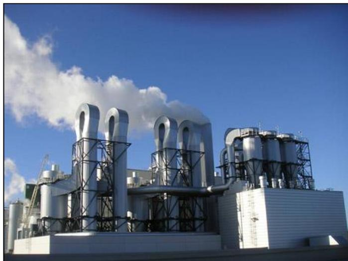
**Figura 22** - Desaguamento térmico, *Flash Dryer*.
