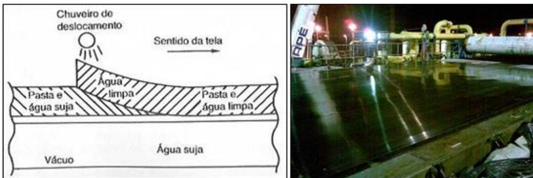
**Figura 17** - Sistema de lavagem por deslocamento (mesa plana).
