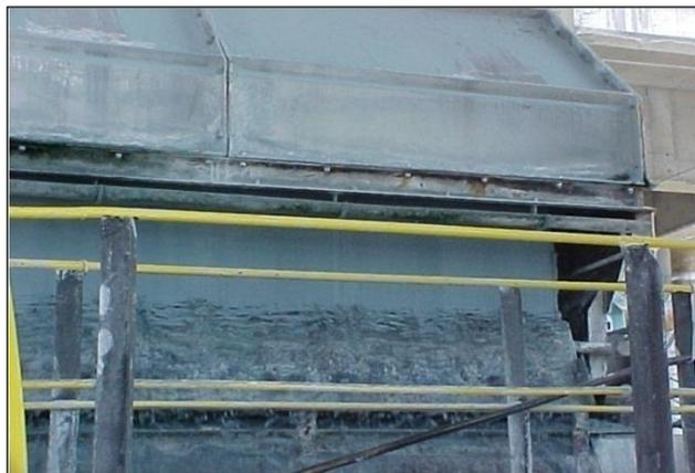
**Figura 31** - Filtro de lavagem da lama de cal.
