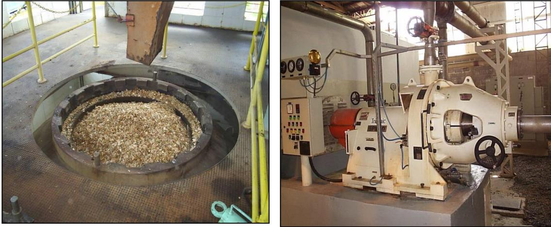
**Figura 10** - Detalhe do digester e do desfribador de cavacos do Processo de extração de celulose semiquímico.
