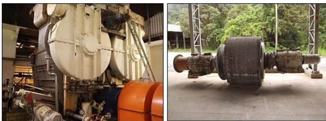
**Figura 8** – Processo de extração de celulose mecânica - TGW
