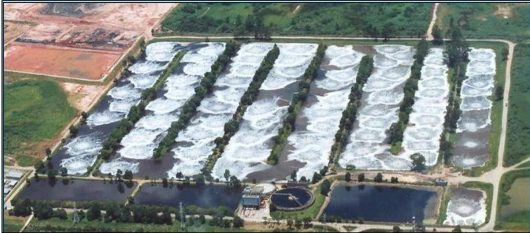
**Figura 41** - Tratamento de efluentes através das lagoas de aeração.
