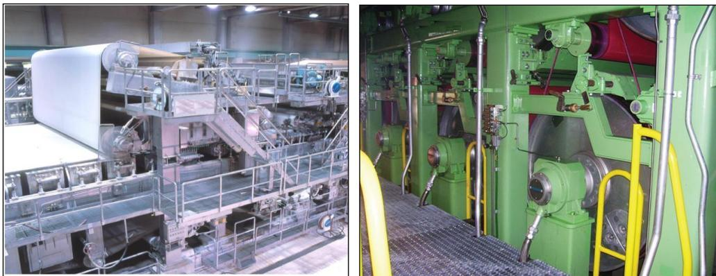
**Figura 23** - Caixa de entrada e cilindro secador da máquina de papel.
