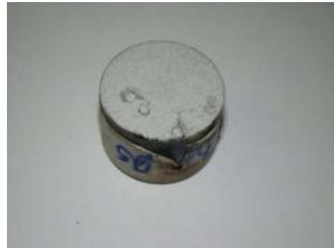
Figura 37 - Varistor B1-05 - Falha 40 kA.
