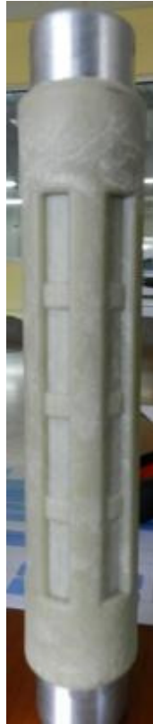
Figura 20 - Alívio de material no módulo elemento varistor.
