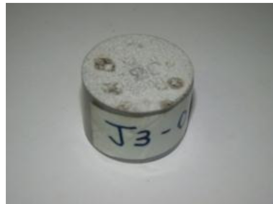
Figura 48 - Varistor J3-03 - Falha 65 kA.
