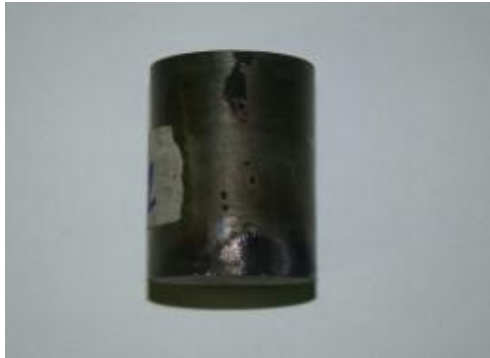
Figura 38 - Varistor C2-02 - Falha 40 kA.
