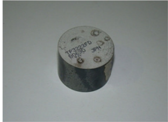
Figura 44 - Varistor B1-02 - Falha 65 kA.
