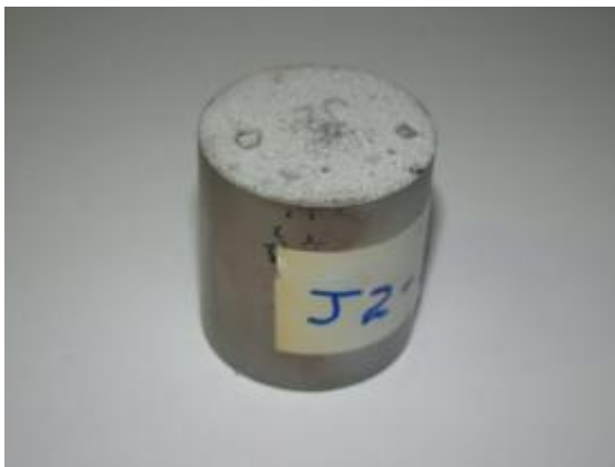
Figura 47 - Varistor J2-02 - Falha 65 kA.
