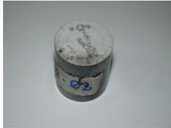
Figura 46 - Varistor B2-02 - Falha 65 kA.
