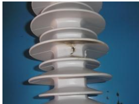
Figura 27 - Evidência de falha da amostra A03.
