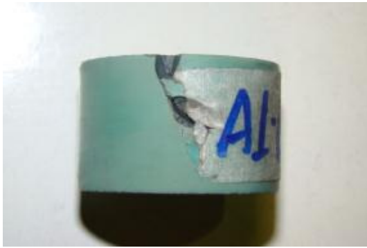
Figura 36 - Varistor A1 - 03 - Falha 40 kA.
