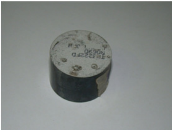
Figura 45 - Varistor B1-03 - Falha 65 kA.
