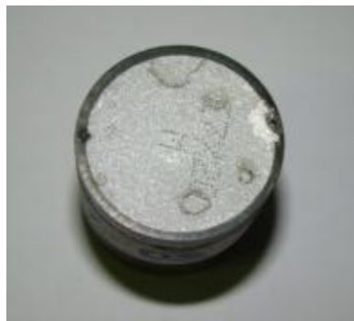
Figura 42 - Varistor C2-05 - Falha 150 A.
