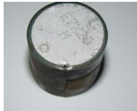
Figura 41 - Varistor C2-04 - Falha 150 A.
