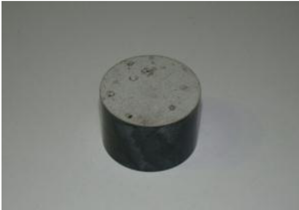
Figura 43 - Varistor B1-01 - Falha 65 kA.
