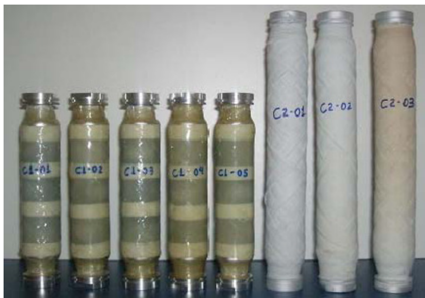
Figura 49 - Módulo de 15 e 24 kV Construídos pelo Método de Roving - Montagem com Fio de Fibra de Vidro com Resina Epóxi
