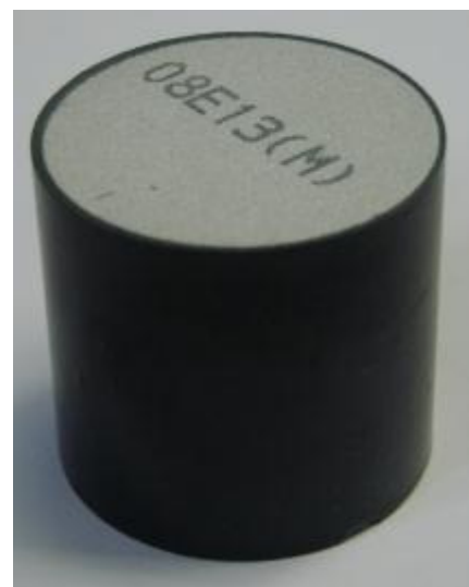
Figura 13 - Varistor do fabricante II
