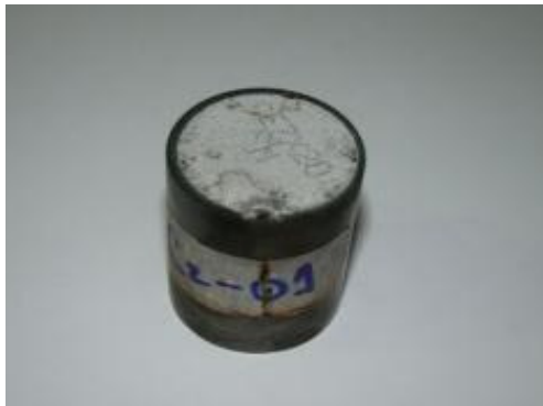
Figura 40 - Varistor C2-01 - Falha 150 A.
