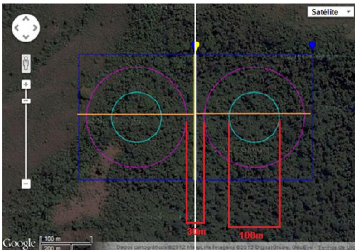
Figura 3: Distancias de estimativa dos perfis concêntricos em um perfil longitudinal (linha laranja).
