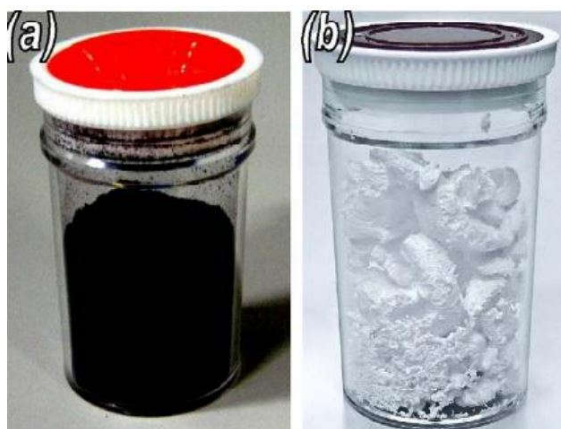
Figura 1.2 - Apesar dos comprimentos de ligação C-C e B-N serem próximos os (a) Nanotubos de carbono e (b) nanotubos de nitreto de boro possuem diferentes características físicas. Um exemplo é a cor, que é escura para os nanotubos de carbono e branco para nanotubos de BN. Fonte: International Journal of Emerging Technology and Advanced Engineering Volume 2, Edição 10, Outubro de 2012 [18].
