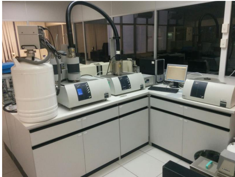
Figura 24 – Vista do Equipamento de Termogravimetria para análise de DTA/TG da Agilent Netzsch
