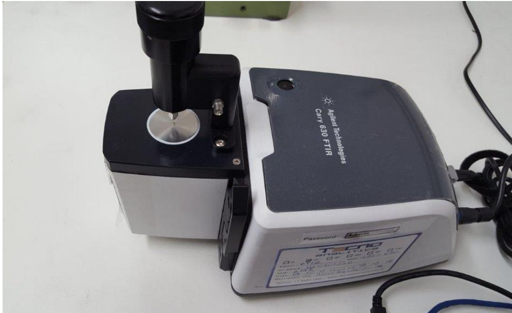
Figura 23 – Vista do Equipamento de Espectroscopia Vibracional no Infravermelho por Transformada de Fourier (FTIR) da Agilent Technologies .
