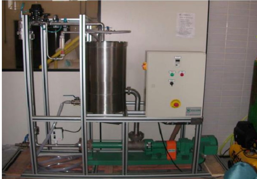
Figura 8 - Piloto do equipamento de purificação através de microfiltração tangencial Netzsch®. Fonte: Guedes e Lapolli, 2012, apud Pelegrin, 2004.
