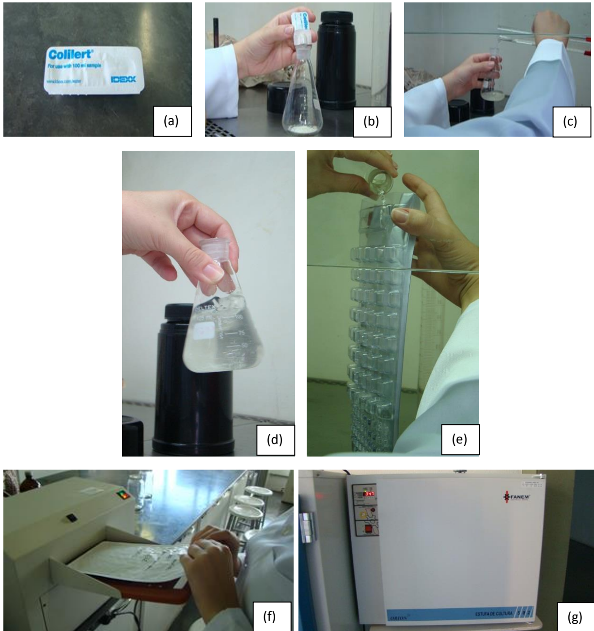
Figura 31 - Procedimento experimental para análise de coliformes (a) cápsula de Colilert®, (b) transferência do substrato ao Erlenmeyer, (c) transferência da amostra contida na proveta, (d) diluição através de movimento circular, (e) transferência da amostra para a cartela, (f) cartela contendo a amostra sendo lacrada e (g) estufa de cultura onde a amostra permaneceu por 24h.
